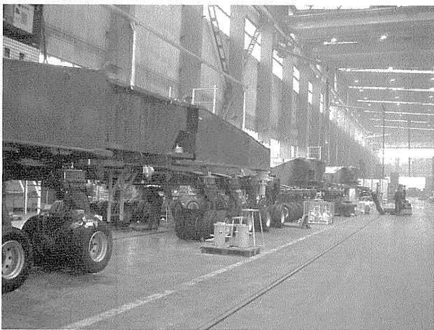
写真—49 モバイルクレーン組立て状況
