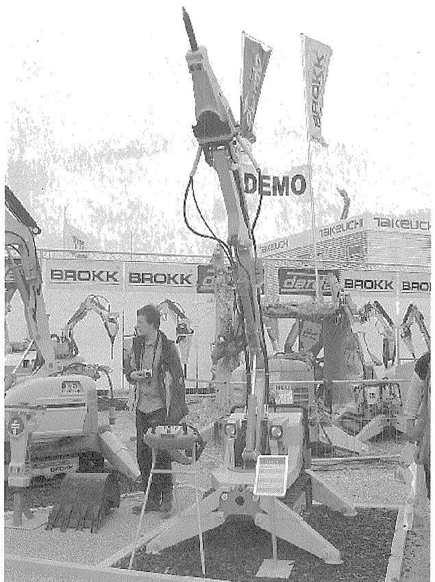
写真-34 自走式ミニブレーカ(Brokk 90)
