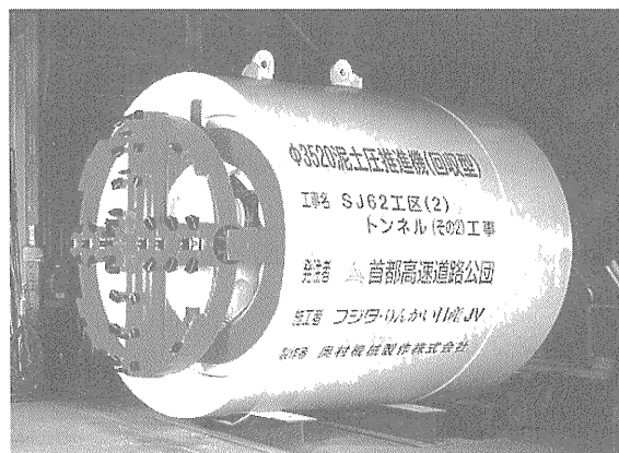
写真—6 カッタ縮径状況
