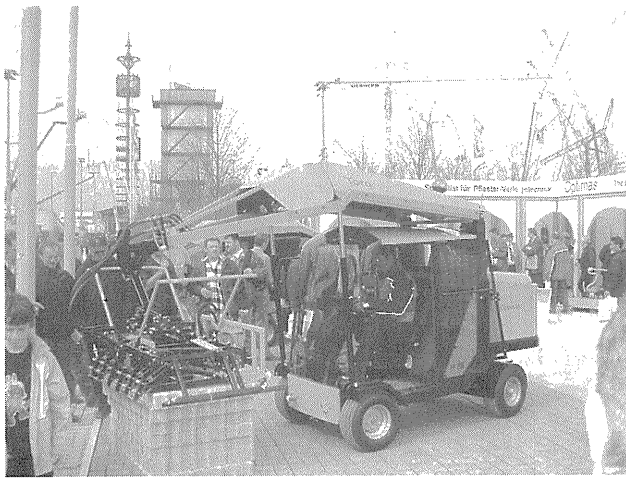
写真—35 インターロッキング設置機械
