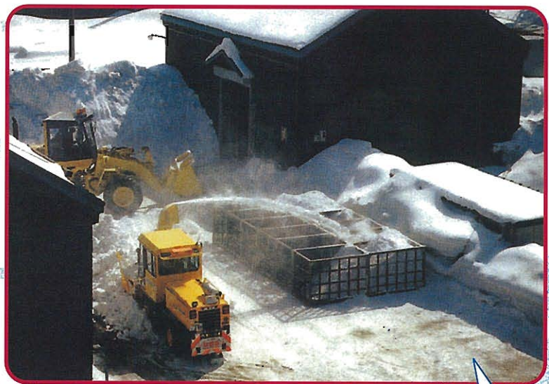
ロータリー除雪車による雪コンテナへの雪の投入
