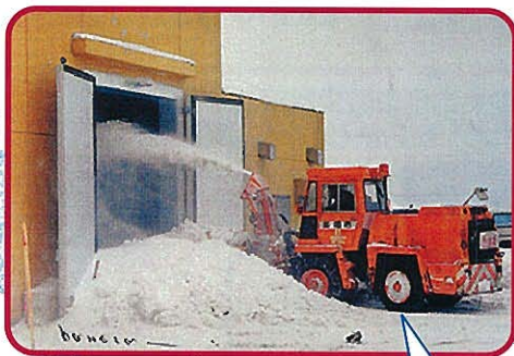
ロータリー除雪車による 貯雪庫への雪の投入
