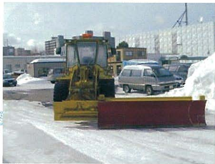
⇩横断歩道部の開口処理除雪機
