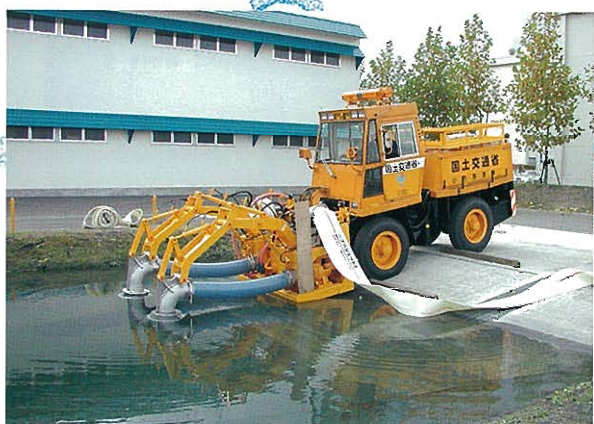
⇩排水ポンプ装置の性能確認試験
