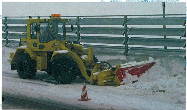
⇩防雪柵柵下除雪状況
