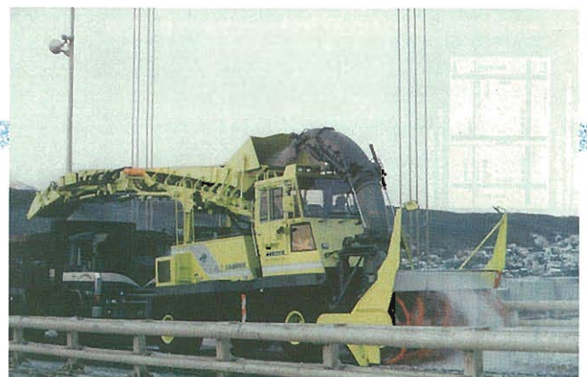
⇩一車線積込型ロータリー除雪車による排雪作業
