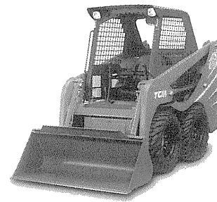
写真一 TCM「SSL」706 ホイールローダ (スキッドステアリング形)
