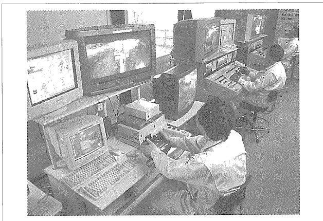
写真-1 函内掘削機遠隔操作状況
