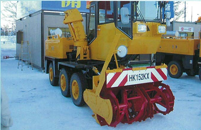
↑後方投雪型小型ロータリ除雪車
