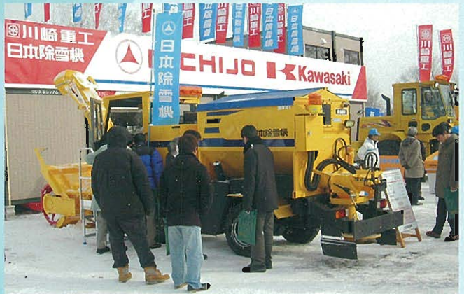
↑散布装置を搭載した小型除雪車
