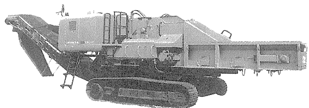
写真-5 日立建機 ZR 130 HC 木材破碎機（自走式）
