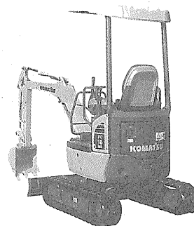
写真-2 コマツ「GALEO」PC 18 MR 2 ミニショベル (後方超小旋回形)
