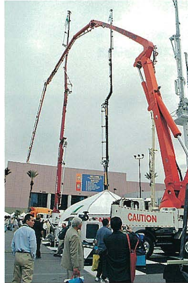
⇨SCHWING AMERICA社 約55mのboomを持つ大型コンクリートポンプ
