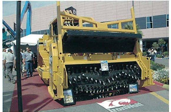
⇨IRONWOLF社 クラッシャと呼ばれる路面切削機
