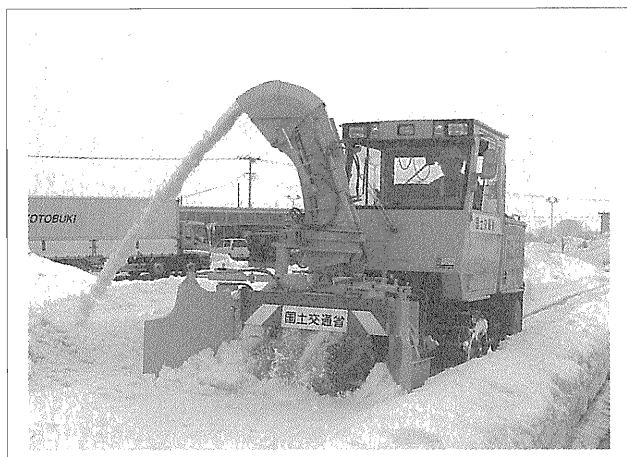
写真—1 除雪幅可変型小型除雪機械
