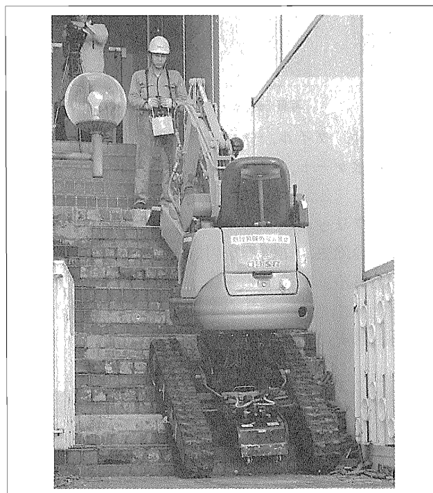
写真-2 階段の昇降。オペレータは遠隔操作で運転を行う
