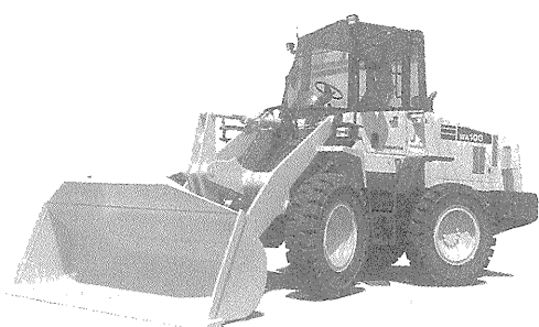
写真—4 コマツ「GALEO」WA 100 s ホイールローダー (産業廃棄物処理仕様車)
