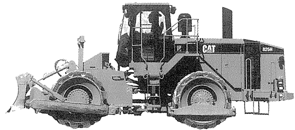
写真-6 新キャタピラー三菱CAT 825Hタンピングローラ
