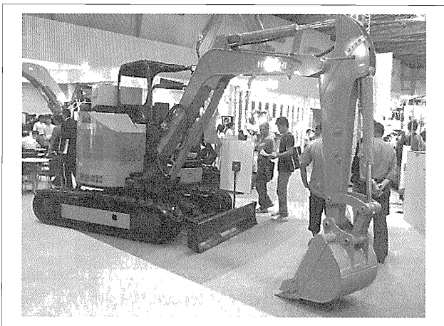
写真—9 日立建機 2 電源式バッテリーショベル
