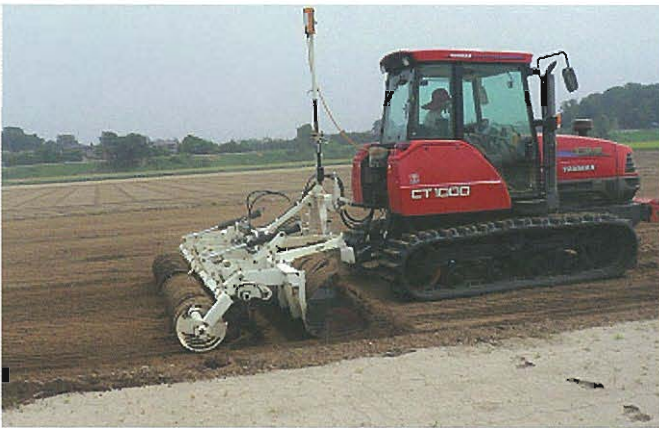
⇩ レーザー制御による圃場面の均平化・着装型レーザーレベラー
