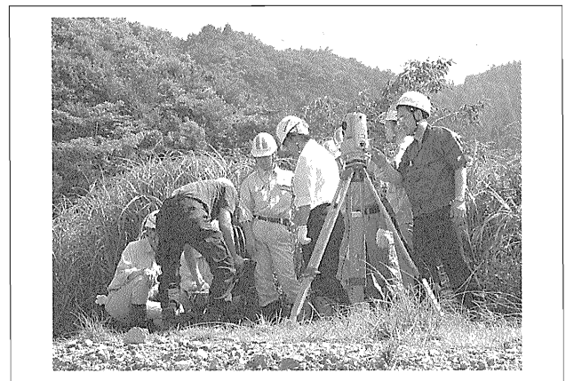
写真-7 トータルステーションへのデータ入力
