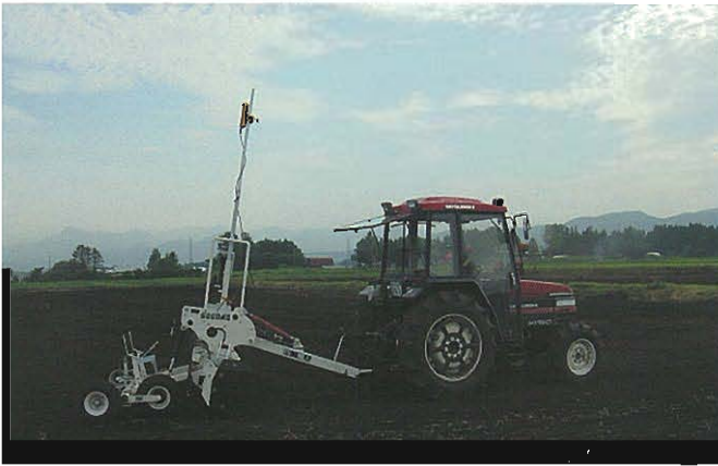
⇩ レーザー制御による圃場面の均平化・牽引型レーザーレベラー
