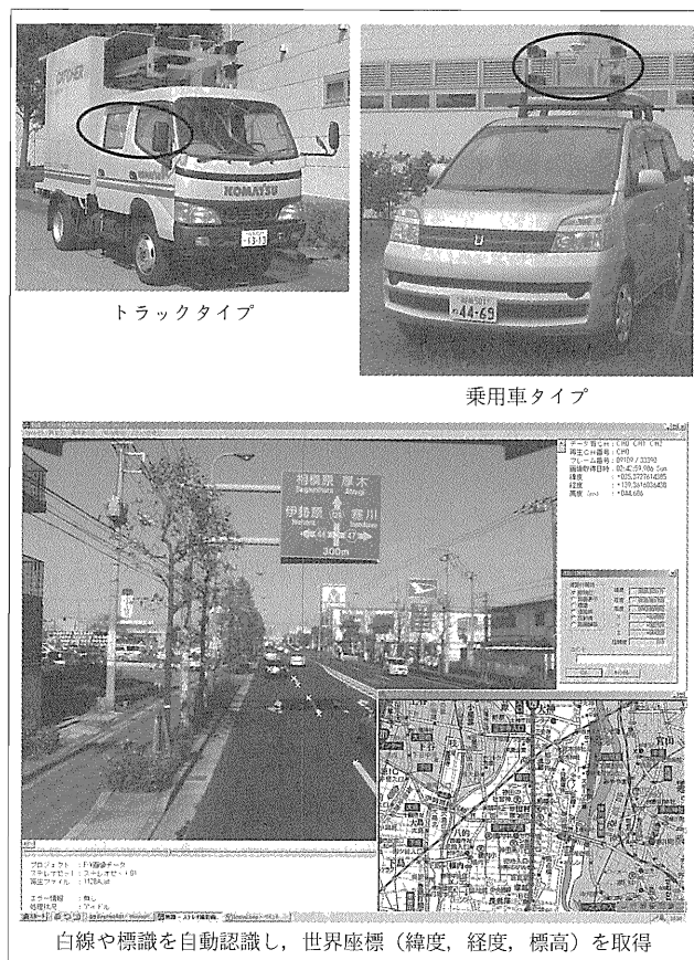
図-8 GPS との組合せ（計測車の目）
