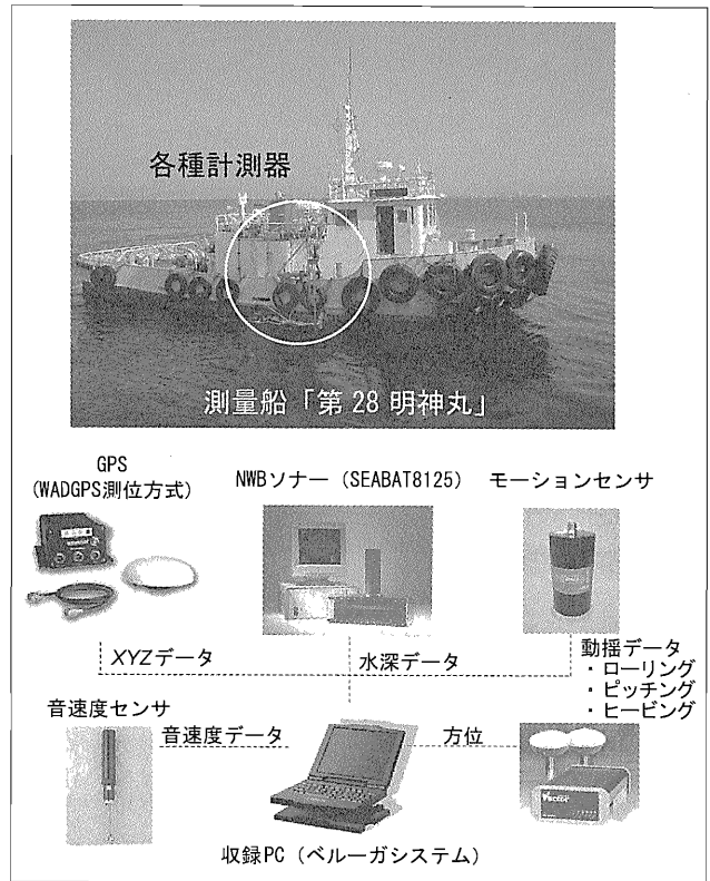
図-4 ベルーガシステム構成
