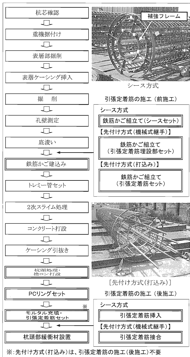
図-5 CTP 工法の施工フロー
