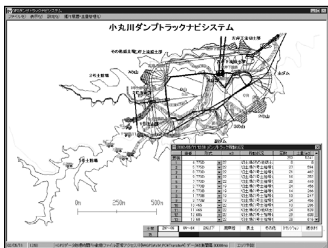
図-8 ダンプトラックナビシステム
