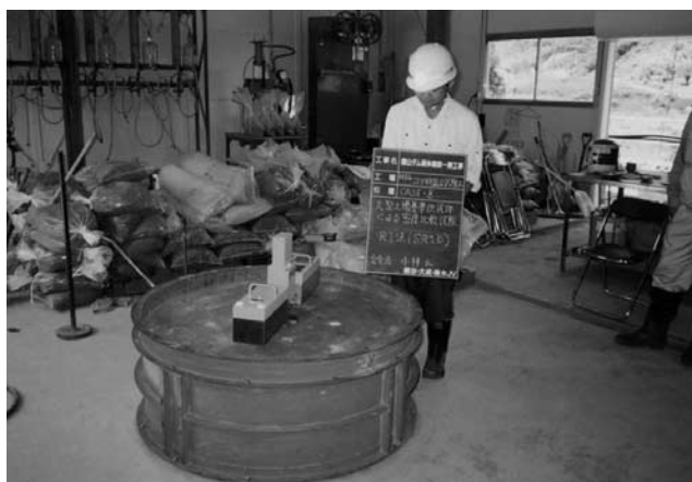
写真—8 自動走査式 (SRID) RI による現場密度試験
