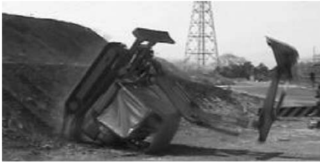
写真—1 事故再現実験（斜面よじ登り後転）
