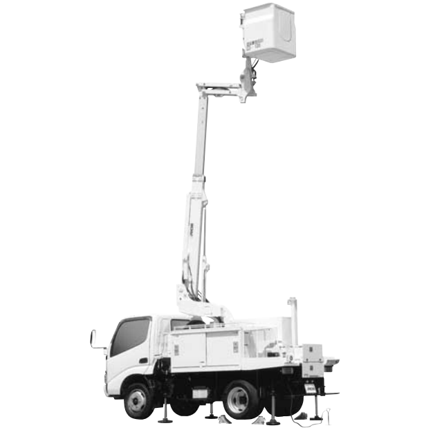
写真二 アイチコーポレーション「スカイマスター」SE08C 高所作業車
