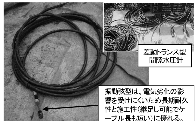
写真—21 振動弦型間隙水圧計、真綿川ダム
