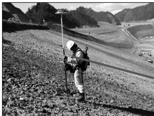
図-7 三次元ワンマン測量システム
