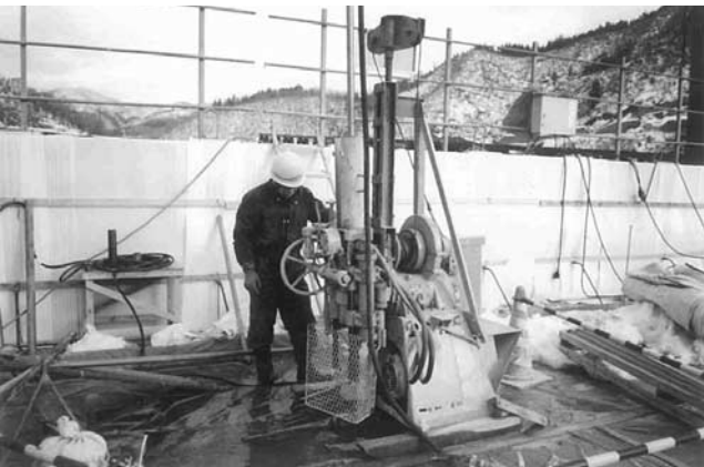
写真—1 ロータリーボーリングマシン
