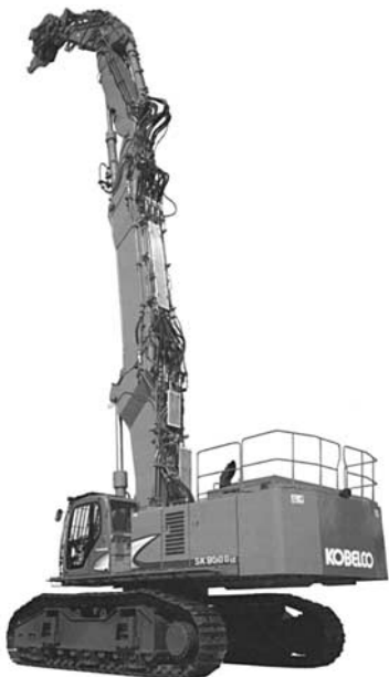
写真一５ コベルコ建機「DYNASPEC」SK950DLC-2 建築物解体機（インサートブーム仕様）
