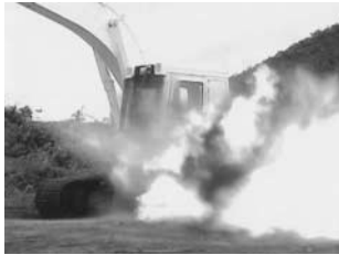
爆風型地雷 OZM2 による爆破試験状況
