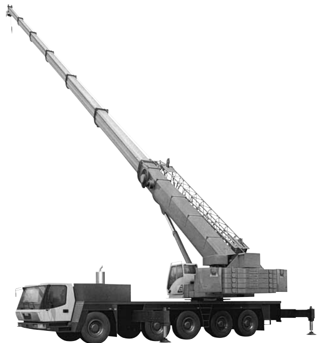
写真—3 コベルコクレーン KMG5220 オールテレーンクレーン
