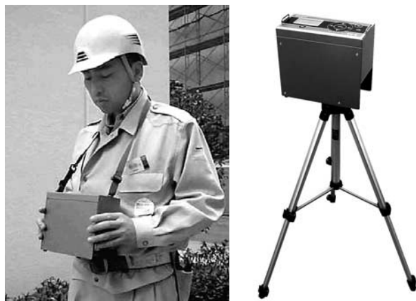
図—10 測定状況（左：携行，右：据置）
