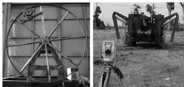
写真ー９ コーナーキューブ回転機構
