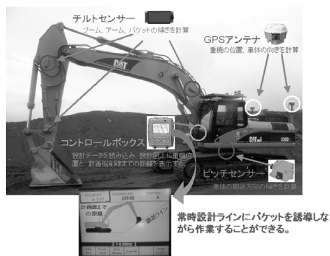
図—5 バックホウ誘導システム
