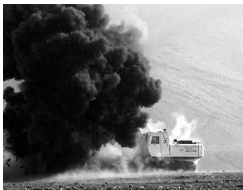
アフガニスタンでの 30 t 級旋回型除去機の爆破試験
