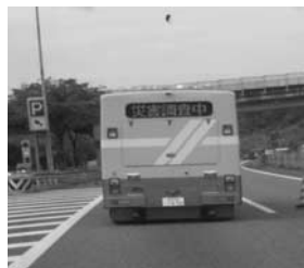
写真-7 調査車による空洞調査
