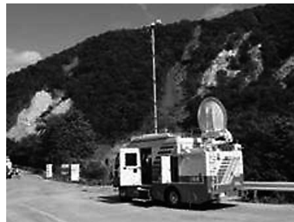
写真—12 通信衛星車による通信確保状況
