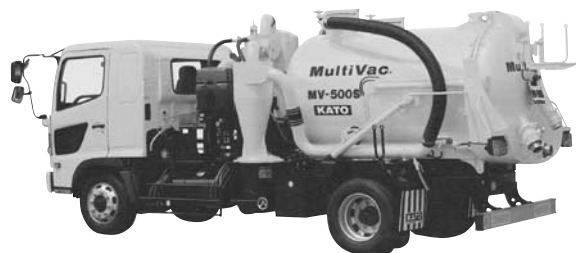
写真—6 加藤製作所「Multi Vac.」MV-500S 側溝清掃車（水封式ブロワ形）
