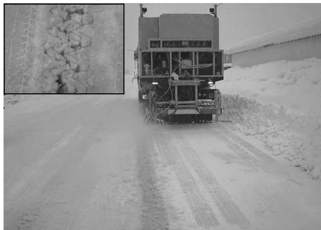
図—19 凍結破壊実験の状況
