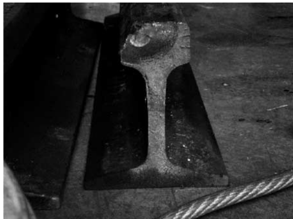
図—1 レール破断例
