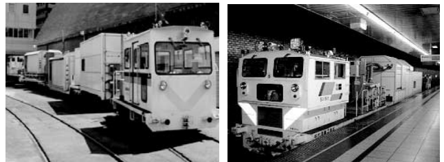
トンネル部用 換気口部用 写真—1 石綿除去専用車両
