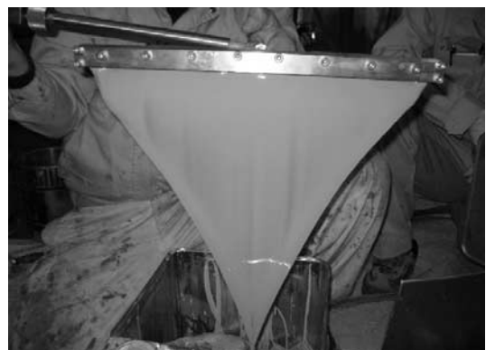
写真一2 ウレア系樹脂吐出状況
