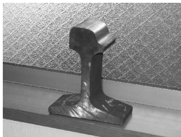
図—10 摩耗交換したレール
