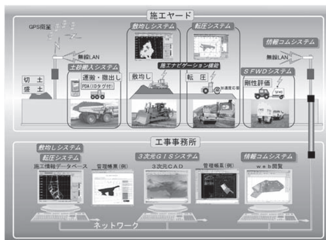
図一1 IT 土工の総合化システム
