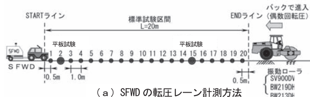
(a) SFWD の転圧レーン計測方法
