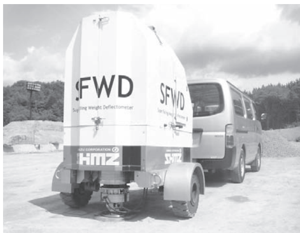
写真—2 SFWDの計測状況
