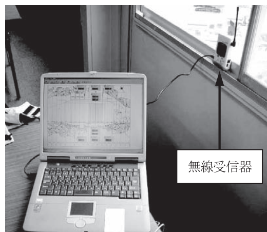
写真-2 試験導入状況（無線受信器と計測管理 PC）
