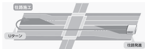
図—9 URUP 工法によるUターン施工
