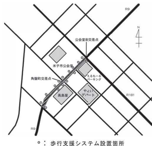
図一四 米子市内の設置状況
