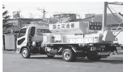
写真三 凍結防止剤散布ユニット搭載状況
