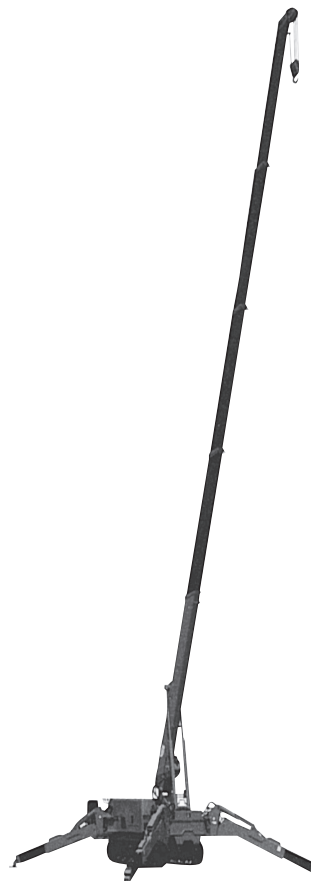
写真—5 前田製作所「かにクレーン」MC405CWMS クローラークレーン
