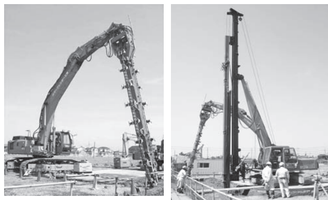
図—2 トレンチャー式地盤改良機（左）とシート展開装置（右）
