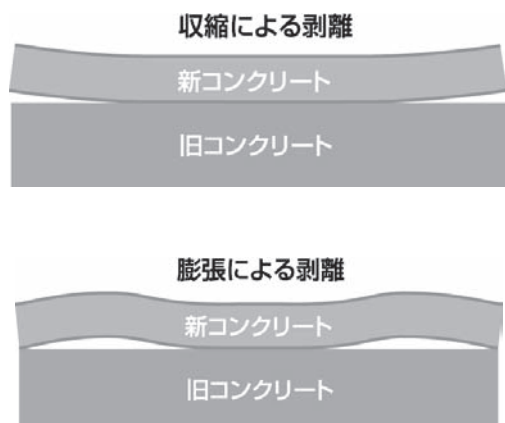
図—1 従来工法では剥離が生じやすい
