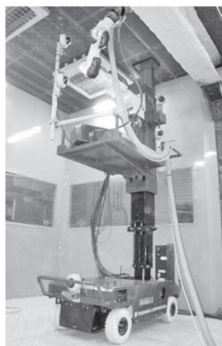
図-2 剥離ロボット
