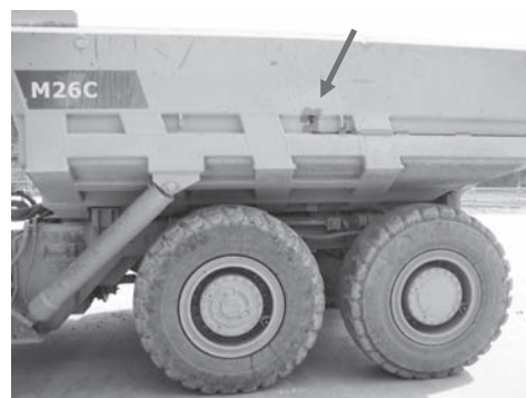
写真—4 左側カメラの装着
