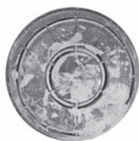
写真—4 防じんフィルタ表面
