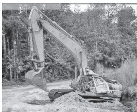
写真—2 転倒後のキャブ損壊の例
