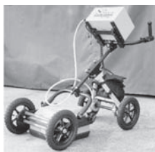
埋設物損傷事故防止対策機 Seeker (シーカー)
