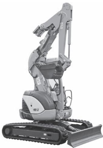
写真一 2 IHI 建機 40VZ ミニショベル (超小旋回形)
