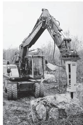
写真—6 アトラスコプコ MB 750 油圧ブレーカ
