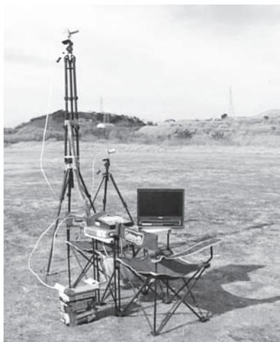
写真一2 地上装置（画像受信装置）外観
