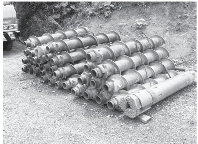
写真一 13 ST 集・排水工法（φ300 mm）
