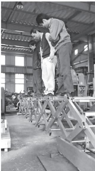
写真-5 載荷試験状況 (大人3名で載荷)
