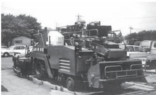
写真4-10 (株)新潟鐵工所 リミキサ NRM400
