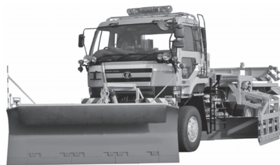
写真一6 除雪トラックの外観
