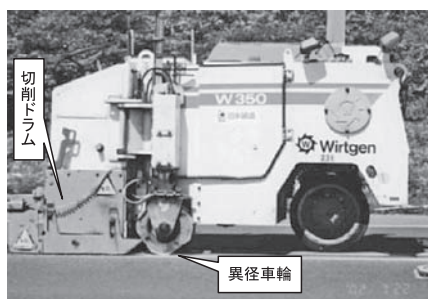
写真—2 施工機械
