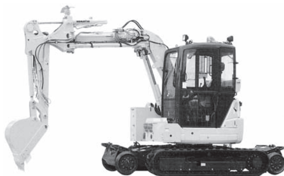
写真-4 コマツ「スーパーライナー」PC58UUT-5 軌陸兼用作業車
