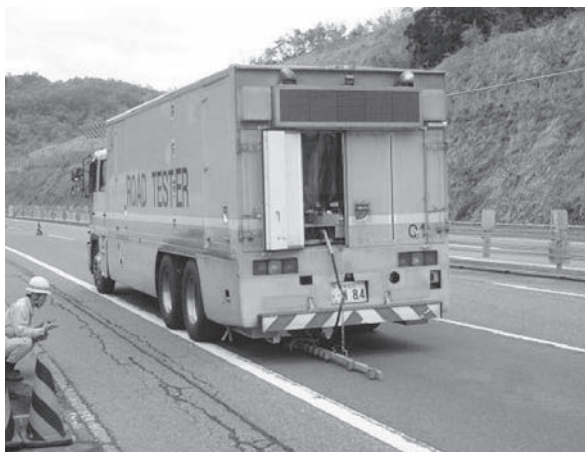
写真—3 高速道路における測定状況
