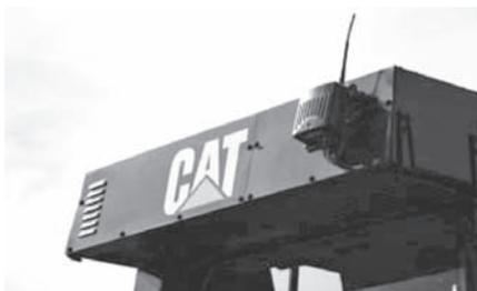
写真一八 電動エアコンディショナシステム
