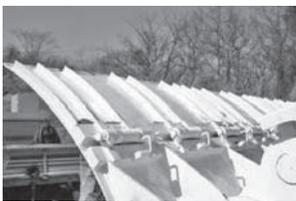
飛散物防止カバーの装着により機材への損傷を最小限に抑える。
