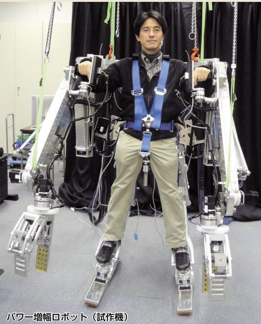
パワー増幅ロボット (試作機)
