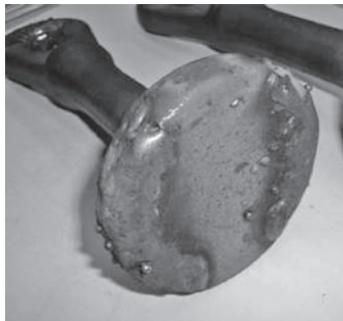
ハンマーの対磨耗性の向上のため、直接地雷を処理するハンマー部の形状と材質については、現地の実証試験が必須であった。そこで様々な種類・材質・形状のハンマーを製作し、ハンマー及びチェーンは現地の技術者にも肉盛り再生ができるようにしたため維持コストの軽減に繋がった。
