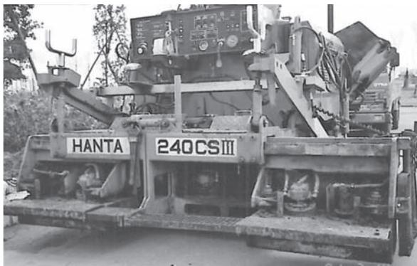
写真7-10 範多機械(株) 水平振動スクリード
