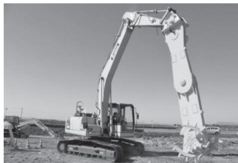
写真—1 WILL 工法施工機
