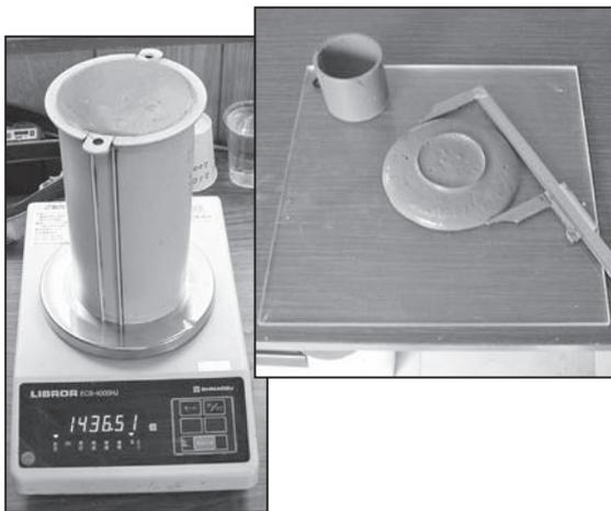
写真一五 密度試験，フロー試験状況
