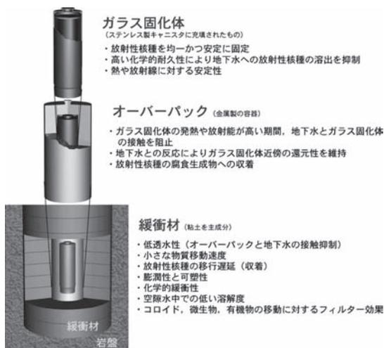
図-2 多重バリアシステムの例<sup>1)</sup>
