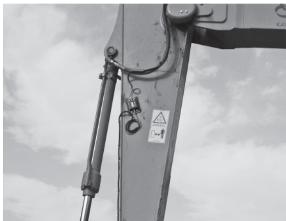
図—3 可動部の角度センサー
