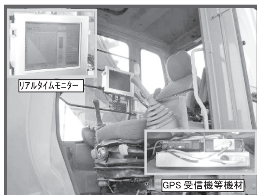
写真四 掘削機械の操作室の様子
