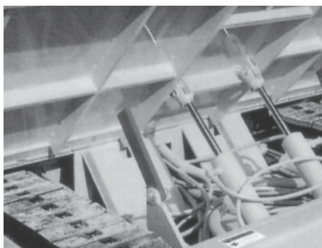
写真10－7 ホッパ前部持ち上げ状態
