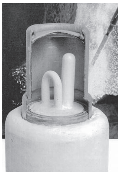
写真-1 測温プローブ先端の熱電対
