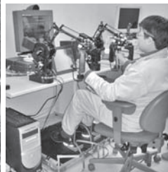
(左) バックホウを運転する人間型ロボット (右) 人間型ロボットの操縦コックピット
