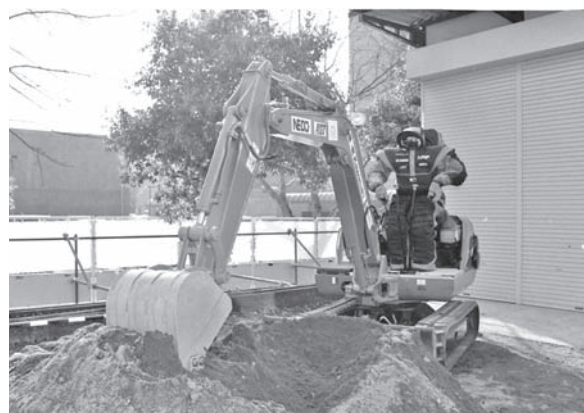
図—3 人間型ロボットによる代行運転
