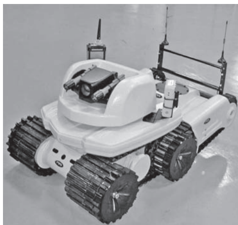
図一七 消防用検知ユニットの搭載例
