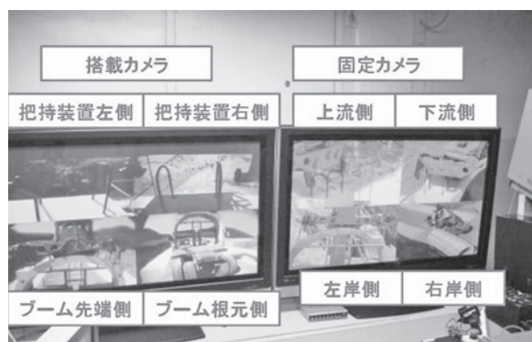
写真-6 遠隔操作室カメラモニター状況
