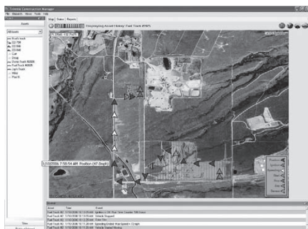
図一 4 搬送路，現場外の搬送路のトラッキング
