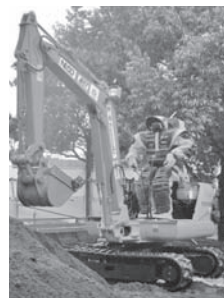
(左) バックホウを運転する人間型ロボット (右) 人間型ロボットの操縦コックピット
