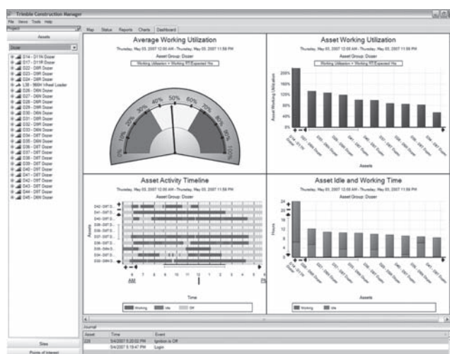
図一 3 使用燃料，移動時間，サイクル回数等の表示
