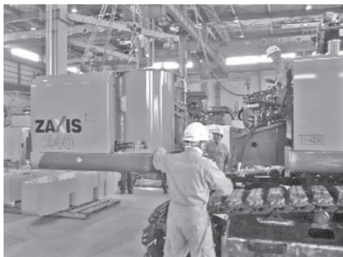
写真—11 下部フレーム接合状況
