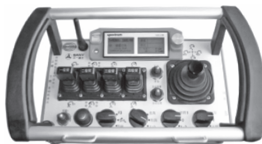
写真-12 リモコンによるブーム制御操作
