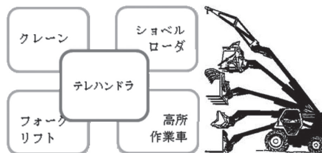
図—1 テレハンドラ特徴の概念図
