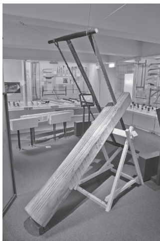
写真—2 縦挽製材鋸（大鋸）
