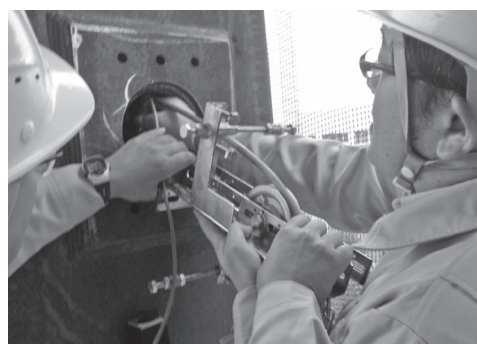
写真-5 圧入口への計測・カメラユニットの取り付け
