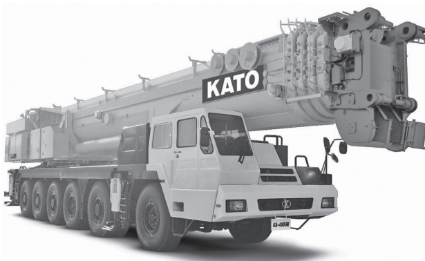
写真－2 加藤製作所 KA-4000R オールテレーンクレーン
