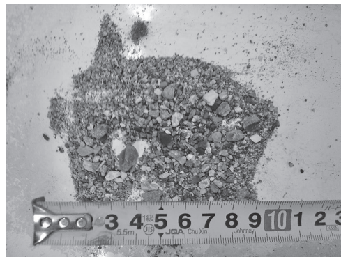
写真—3 採取試料（圧入振動式施工）
