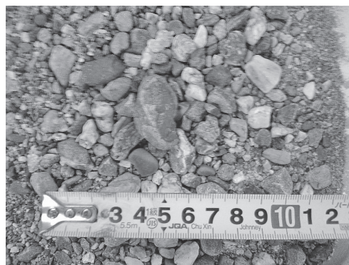
写真—4 採取試料（二重管式施工）
