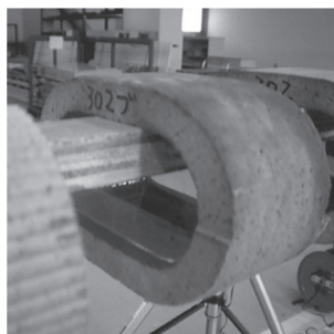
写真12 着色水浸透試験結果
