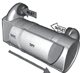
図ー2 ディーゼル酸化触媒／ディーゼルパーティキュレートフィルタ
