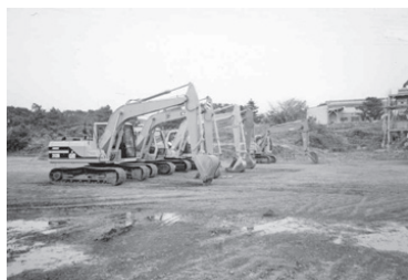
写真一 12t油圧ショベル
