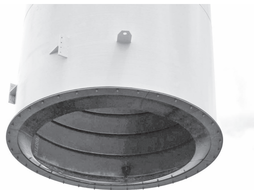
写真－7 ゴム輪取付状況
