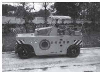
写真 4—30 鹿島道路(株) 冷却装置内蔵タイヤローラ
