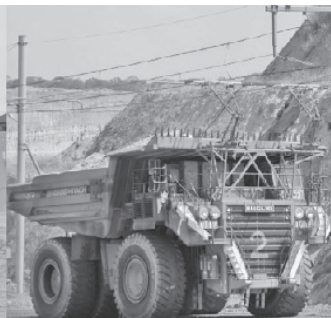
EH4000ACドライブ+トローリーシステム
