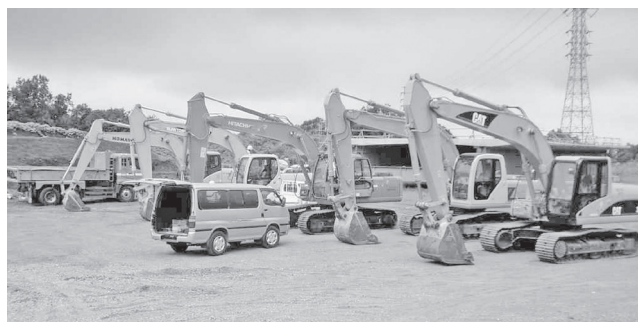
写真一3 20t油圧ショベル
