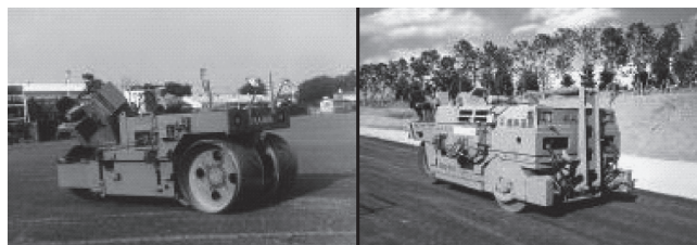
スチールローラ タイヤローラ 写真 4-12 鹿島道路(株) テストコース転圧用ローラ
