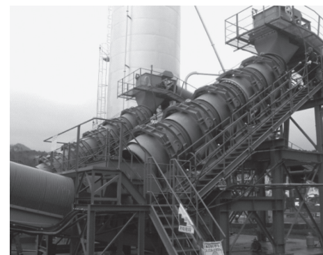
写真—1 混合筒 5 連方式の SP ミキサ
