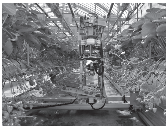
図—5 イチゴ収穫ロボット
