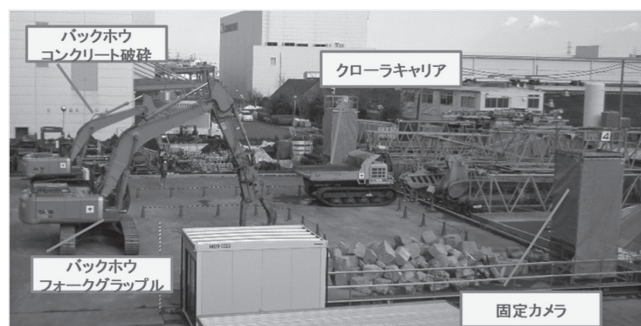
図一3 実験概要（実験に使用した機械と配置）
