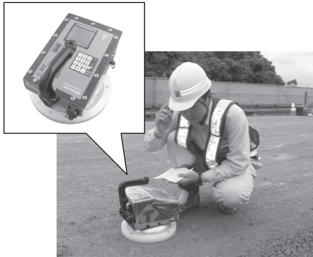
図—15 路盤密度測定機による計測状況
