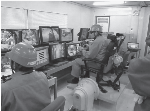
図ー7 操作室における遠隔操作の状況
