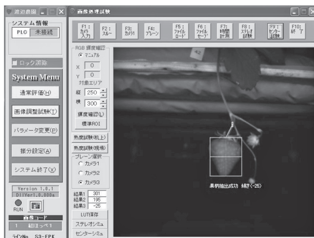
図—6 ロボットの操作画面（果柄の検出）
