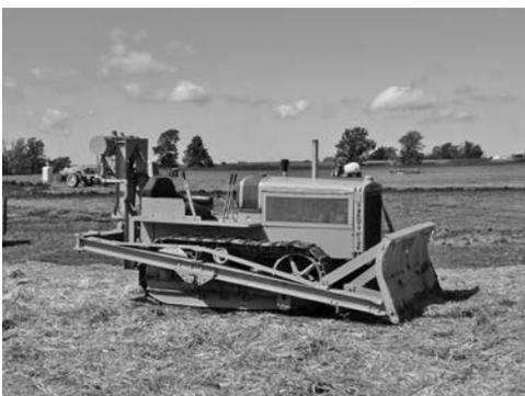
写真—24 キャタピラー 25 型油圧式ブルドーザ, 26 kW ガソリンエンジン (1932 年製)
