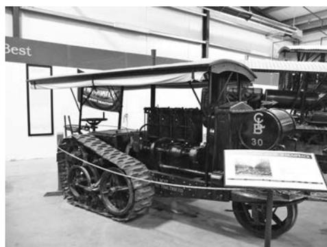
写真—4 C.L. ベスト社 30型トラクタ，22kW ガソリンエンジン（1915年製）
