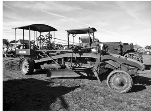
写真—17 マコーミック製農業用トラクタ改造のオースチン社モータグレーダ (1927年製)
