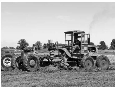
写真一二十 J.D. アダムス社 512 型モータグレーダ, 56 kW ディーゼルエンジン (1948 年製)
