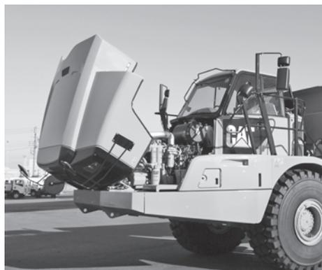
図—12 電動チルトアップエンジンフード
