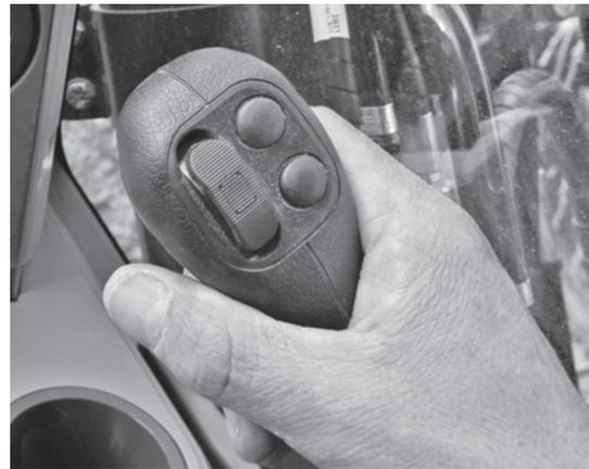
図-6 モジュレーションスイッチ付き操作レバー
