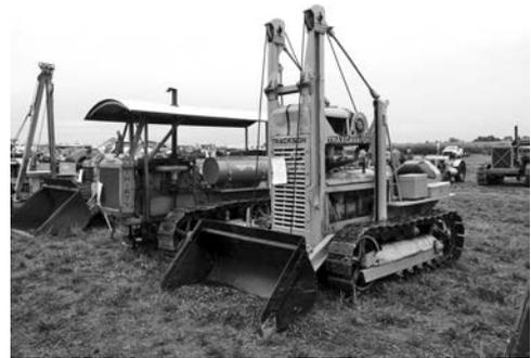
写真-28 キャタピラー社D2トラックカベータ(クロラローダ),
