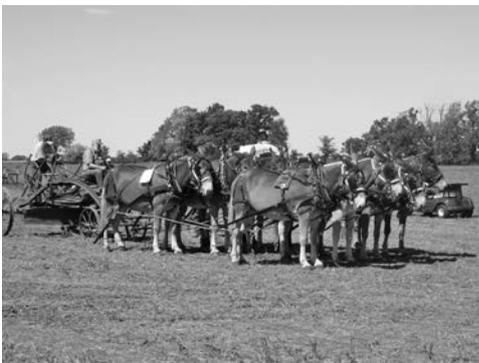
写真—15 8頭だてオースチン社牽引式グレーダ (1917年製)
