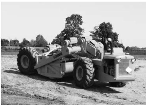
写真-27 R.G.ルターナ社ターナブルD, 4.8m<sup>3</sup>モータスクレーパ,
