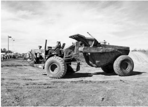
写真-26 WABCO社ターナロッカ9トン積みダンプトラック, 90kW
