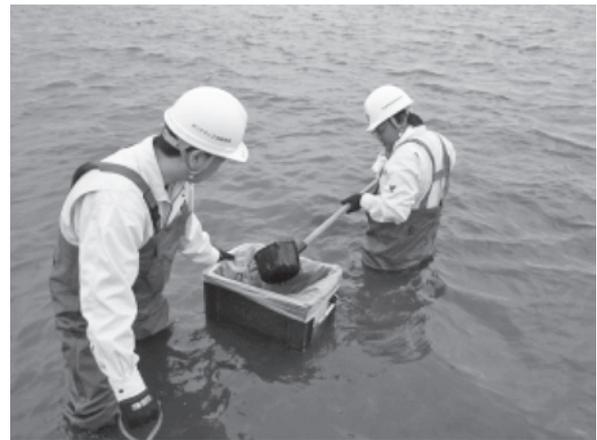
写真—1 津波堆積物サンプリングの様子
