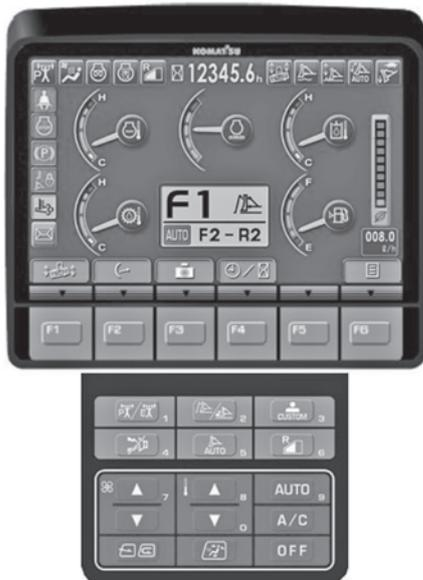
図-9 高精細7インチLCDモニター
