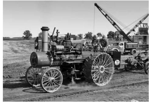
写真一二十一 ラッセル社蒸気トラクタ, 12 kW 蒸気機関 (1920 年製)
