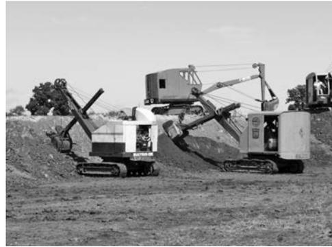
写真—25 ビサイラス・エリー社 10B (1940 年製, 左下), ベイシティ社 20 型 (1939 年製, 右下), シールド・バンタム社 C35 (1955 年製, 左上) の各 10 トン級パワーショベル
