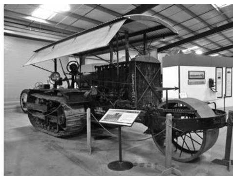
写真—3 C.L. ベスト社 C型トラクタ，55kW ガソリンエンジン（1913年製）
