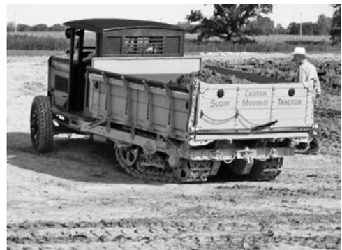
写真一二十二 リン社 428D 型ダンプトラック, 56 kW ガソリンエンジン (1920 年製)
