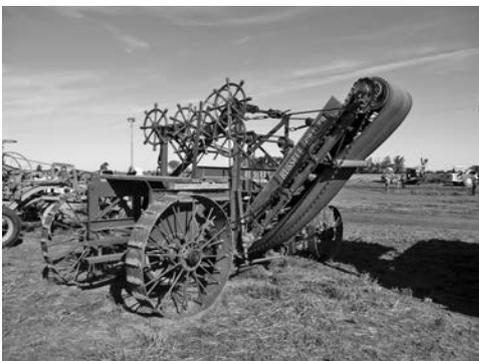
写真—16 ラッセル・グレーダ社タウンシップA型牽引式エレベータリング・グレーダ (1917年製)
