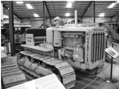
写真—6 キャタピラー社 35 型ディーゼルトラクタ, 26 kW ディーゼルエンジン (1933 年製)
