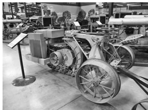
写真—9 ピーン社トラックブルトラクタ, 7.3 kW ガソリンエンジン (1918 年製)
