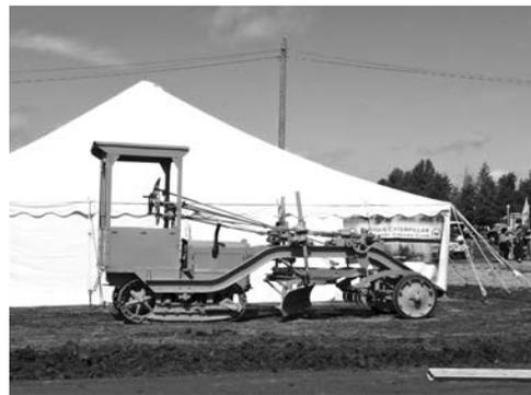
写真—18 キャタピラー15型トラクタ改造のラッセル・グレーダ社モータグレーダ, 11kWガソリンエンジン (1928年製)
