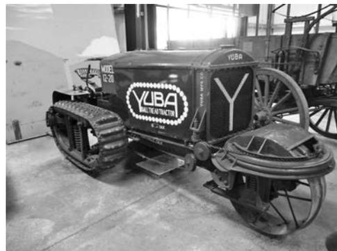
写真—8 ユバ社 12-20 型トラクタ, 18 kW ガソリンエンジン (1916 年製)
