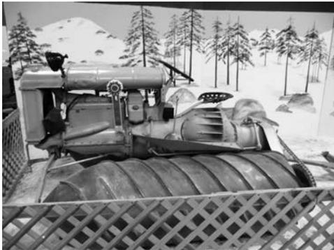
写真一11 フォード社フォードソンF型改造雪上車, 15kW 灯油エンジン (1926年製)
