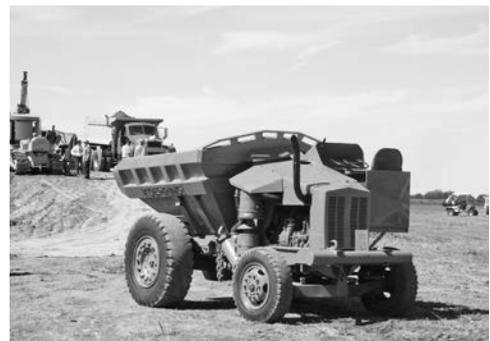
写真-29 コーリング社60-2A「ダンプタ」, 10トン積み (1954年製)
