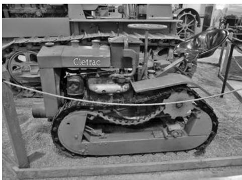
写真—7 クリーブランド・トラクタ社クレトラック F 型トラクタ, 12 kW ガソリンエンジン (1920 年製)
