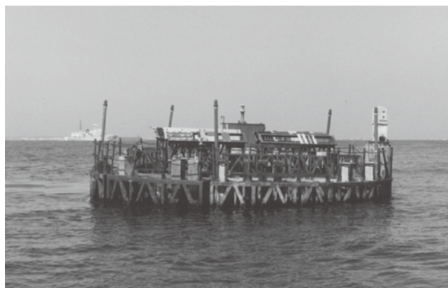
写真—1 コンクリート暴露試験 東京湾海上において 1973 年から 8 年間試験実施
