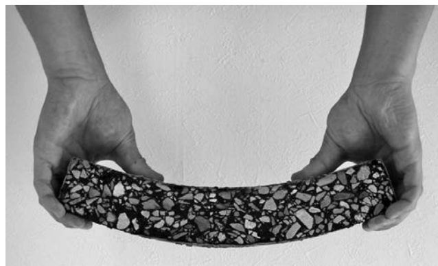
写真—9 「本舗装」のたわみ追従性（厚さ 5 cm, 20℃）
