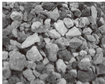
写真—1 フェロニッケルスラグ粗骨材の写真
