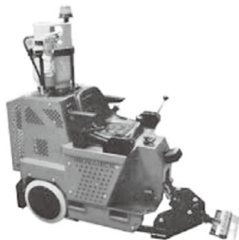
写真—3 搭乗式剥離機
