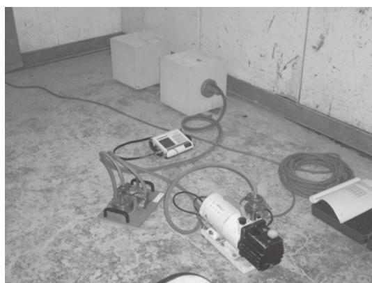
図-5 透気係数測定方法
