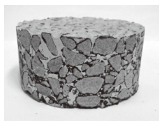
写真—2 半たわみ性舗装材
