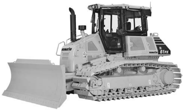
写真ー1 コマツ D61EX-23 ブルドーザ （一部オプションが含まれる）
