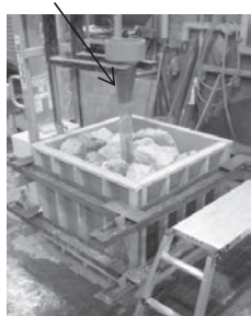
【モルタル注入状況】
