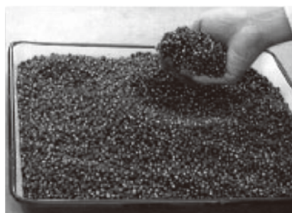
写真—1 発泡ビーズ混合軽量土工法
