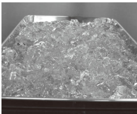
写真—2 吸水後のゲル
