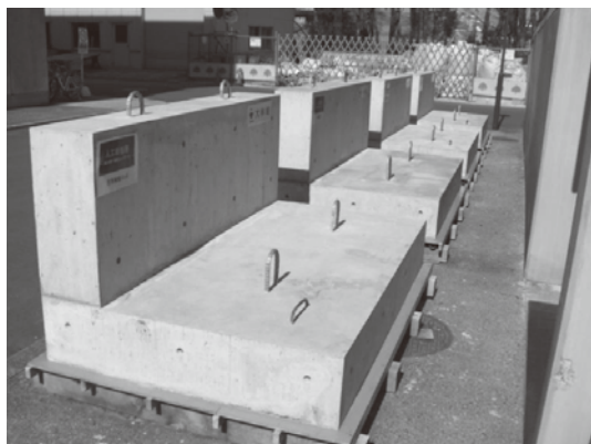
写真—5 海水練り海砂コンクリートを用いたL型ブロック試験体
