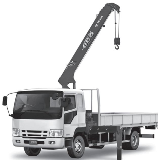
写真—1 タダノ ZE304 カーゴクレーン
