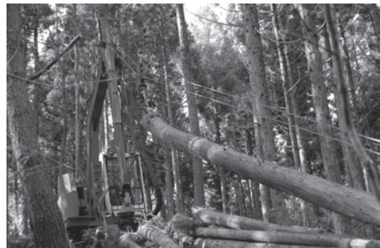
写真-5 スイングヤーダとアーム先端にプロセッサ作業機を持つ機械
