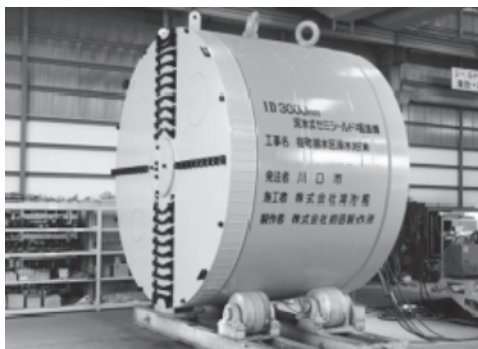
写真—5 φ 3000 mm 用泥水式掘進機
