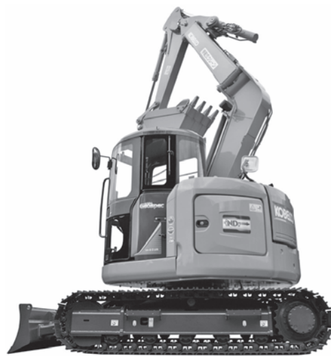
写真—2 コベルコ建機 SK80UR-6 油圧ショベル（超小旋回型）
