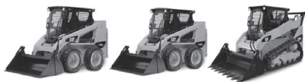
写真—3 キャタピラージャパン Cat 216B 3 /Cat 226B 3 スキッドステアローダ Cat 259B 3 コンパクトトラックローダ
