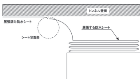
図—9 蛇腹式防水シートの溶着部拡大図
