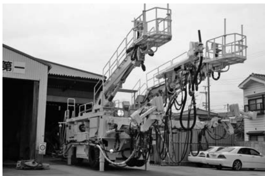
写真—3 タイヤ式エレクター付吹付け機（第3次排出ガス対応型）
