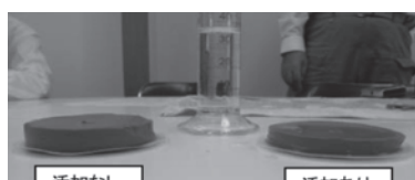
試験装置の円筒内に形成された泥膜。左がAK-2000 添加なし、右AK-2000 添加あり。添加ありの場合はシリンダーに落ちた水量も少なく、薄い泥膜が早期に形成されたことがわかる。
