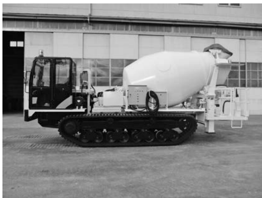
写真—2 ゴムクローラ式ミキサー車（第2次排出ガス対応型） 最大積載量 4.5 m 3 悪条件の路盤を克服
