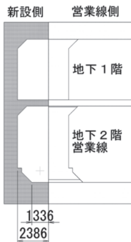
図一4 最も狭い工事箇所の断面図
