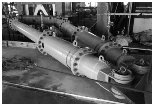
写真-6 タワークレーン用制震装置
