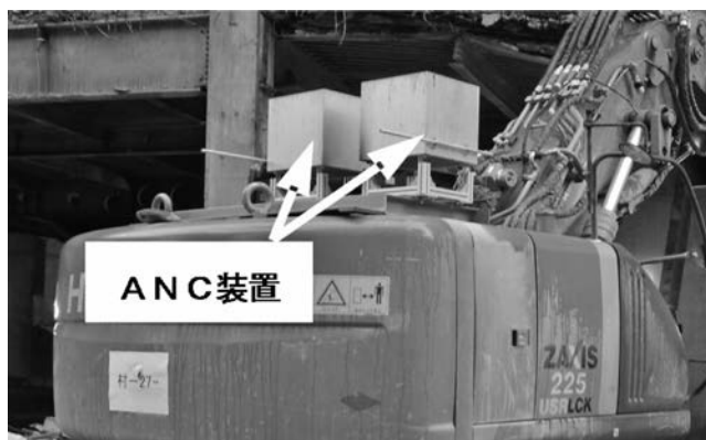
写真—5 ANC 装置の装着状況
