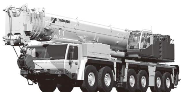
写真—6 タダノ ATF400G-6 オールテレーンクレーン
