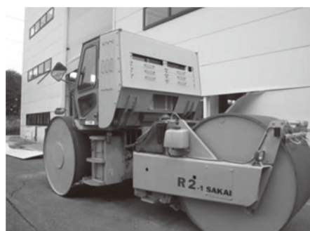
図－13 重遮蔽振動ローラー
