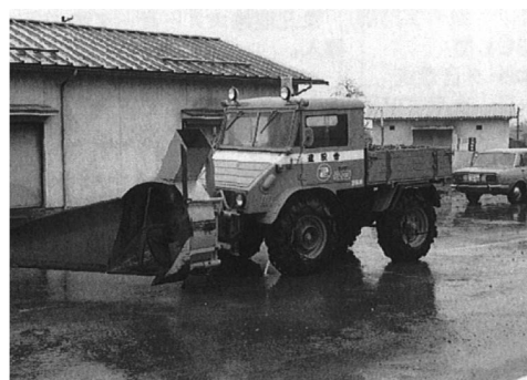
写真 2-14 プロア型ワンステージ 32PS シュミット社 昭和 37 年 2)
