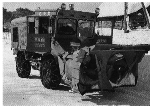
写真 2-17 ブロア型（2 ブロア）ワンステージ、バイルハック社
