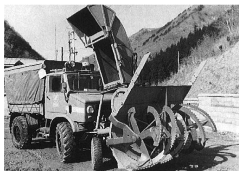
写真 2-18 リボンスクリュ、ツーステージ川崎ロールバ、KRH800 ロールバ社（スイス）昭和 38 年 2)
