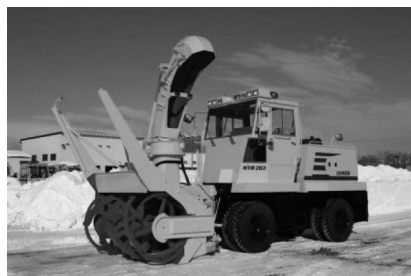
写真 1-1 ロータリ除雪車
