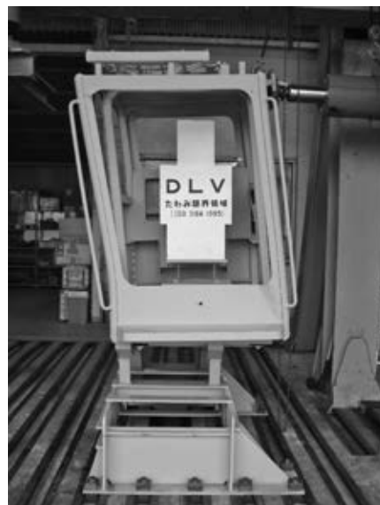
写真一 8 ROPS 側方載荷試験状況
