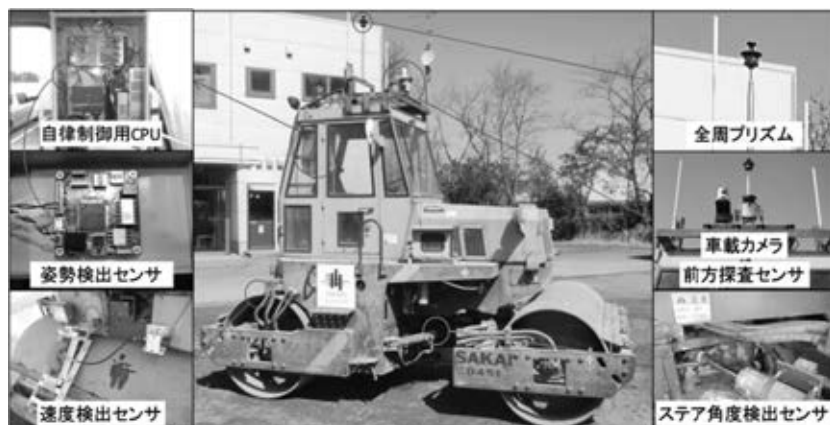
図—14 振動ローラと搭載センサ
