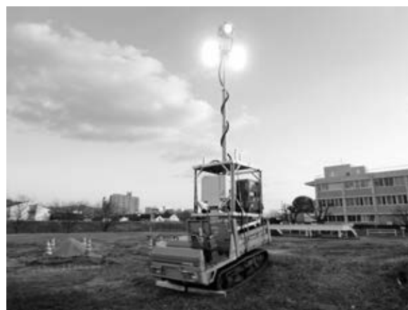
写真—6 不整地運搬車に搭載した災害対策用照明装置
