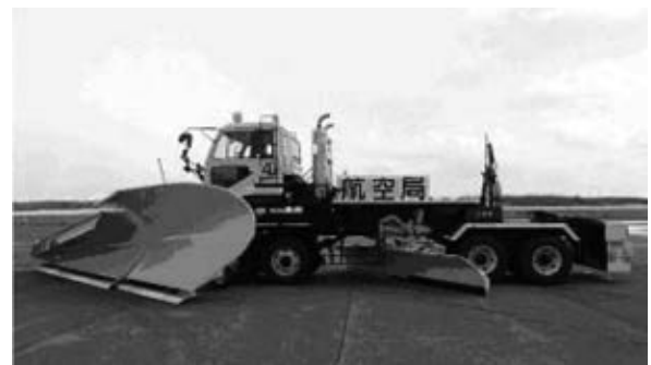
写真 3-26 10t級 8×8 空港用高性能プラウ除雪車 平成 15 年
