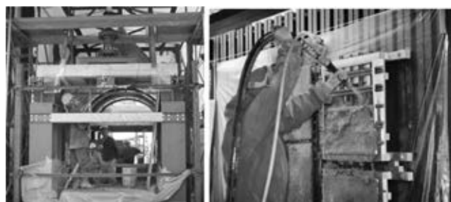
写真—5 吹付け材料の性能評価試験
