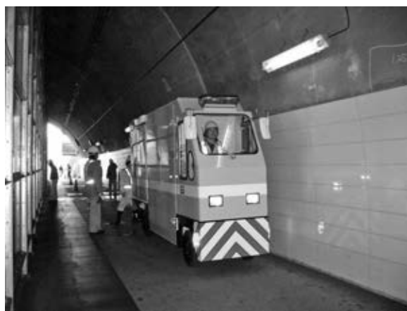
写真—1 トンネル壁面清掃車の実証試験の状況
