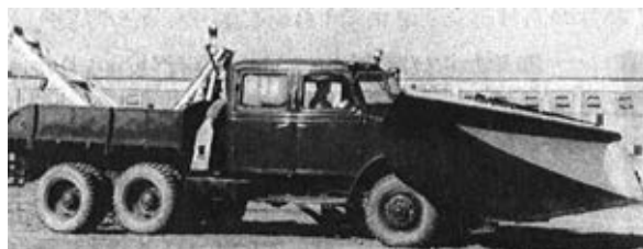
写真 3-9 5 t 級 6 × 6（6 輪全駆）ダンプトラック北海道開発局 昭和 31 ～ 33 年 1)
