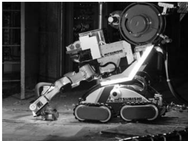
写真—7 本作業ロボット（福島第一原子力発電所内での除染作業）
