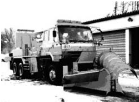
写真 3-22 10t級 6×6 ワンマン除雪トラック 平成 5 年
