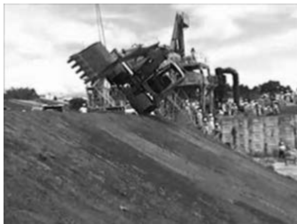
写真—3 油圧ショベルの転倒実験の状況
