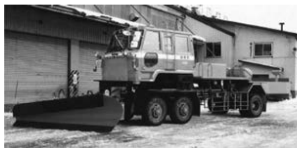
写真 3-16 10t 級 6×6 B・B-D 型除雪試験車 北海道開発局 昭和 62 年
