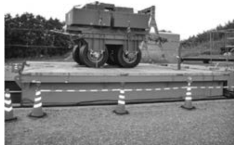
写真—2 屋外輪荷重疲労試験機（280 kN）
