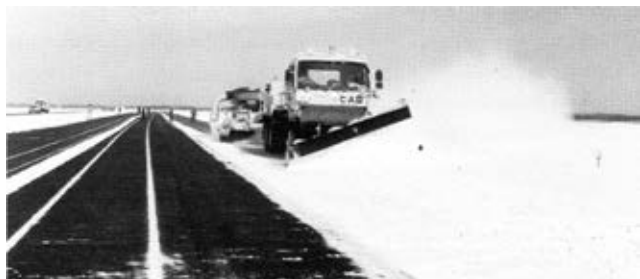
写真 3-15 空港用大型プラウで滑走路を除雪する空港用除雪トラック 昭和 61 年
