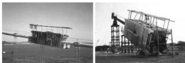
図—2 吊橋ケーブル補修用作業車 (ケレン作業車、ラッピング作業車) 施工性能調査 (本州四国連絡橋公団 平成 5 年度)
