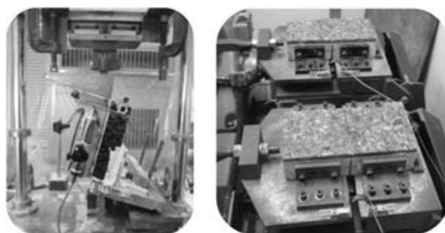
写真—6 防水層の性能評価試験機
