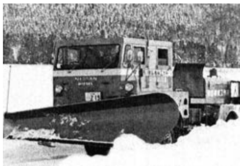
写真 3-12 初めてキャブオーバー形除雪トラックを試験導入 北海道開発局 昭和 46 年 1)
