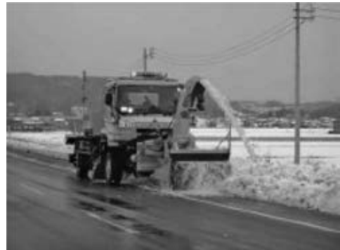
写真 3-25 10t級 4×4 多機能型除雪車 平成 14 年
