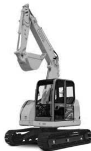
写真－5 加藤製作所 HD308US-6 油圧ショベル
