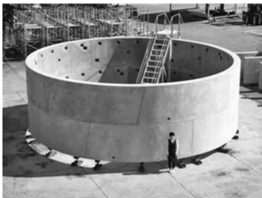
写真—7 一般部セグメント
