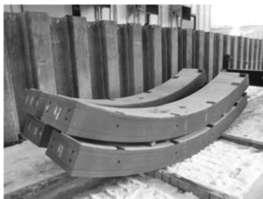
写真—8 曲線部セグメント
