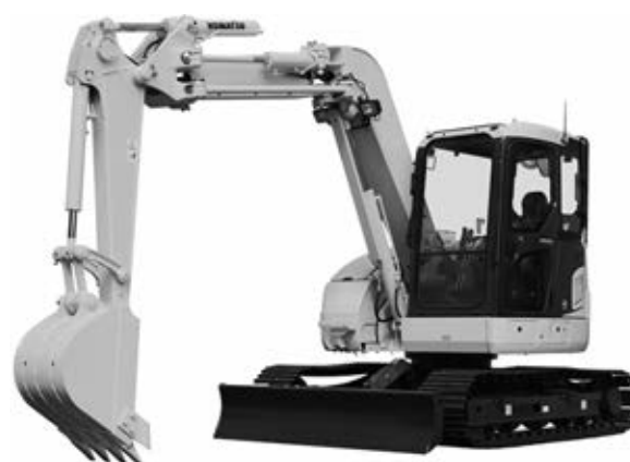
写真一4 コマツ PC78UU-10 油圧ショベル (一部オプションが含まれる)
