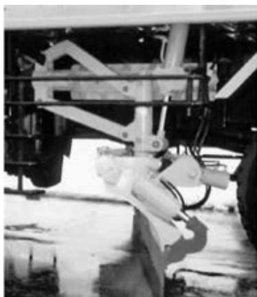
写真 3-105 切削角可変式ブレード 平成 2 年
