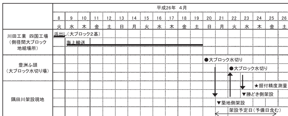
図—6 側径間大ブロックの架設工程
