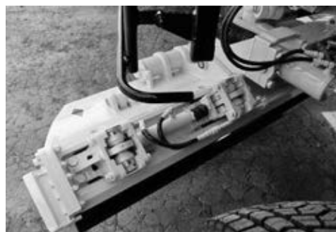
写真 3-109 横送り式エッジワンタッチ着脱ブレード 平成 4 年
