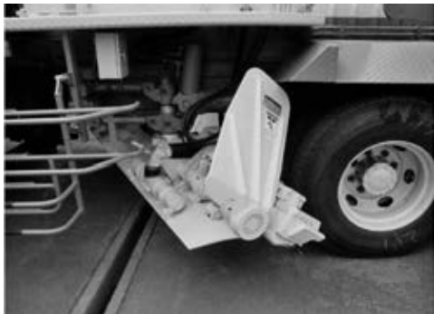
写真 3-114 切削角調整対応形シャッタブレードブレード 平成 15 年
