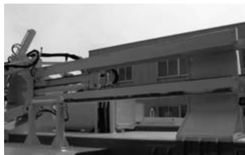
写真 3-132 直列油圧シリンダ方式切換装置 平成 13 年
