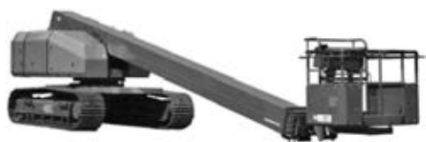
写真—9 アイチコーポレーション SR21CSM クローラ式高所作業車
