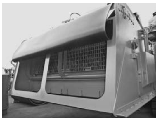
写真一2 フード内スクリーン
