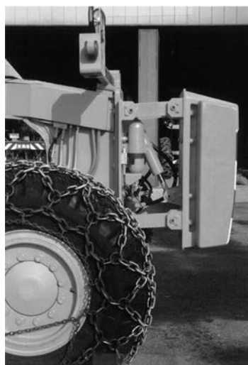
写真 4-111 ダイナミックダンパ フロントカウンタウエイト式 平成 4 年
