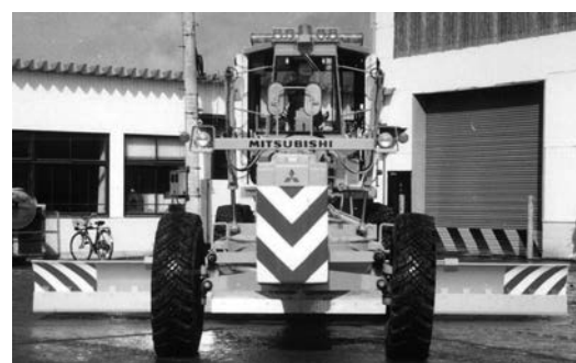
写真 4-106 作業幅員可変形ブレード（4.0m 時写真上，6.0m 時写真下） バリアブルブレード 平成 2 年
