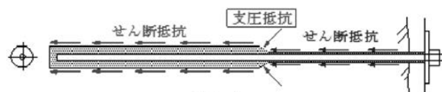
図—2 拡底ロックボルトの耐荷機構
