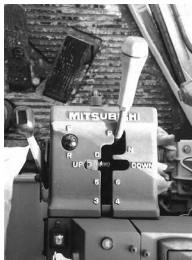
写真 4-114 ダイレクトパワーシフトによるオートマチックトランスミッションのシフトレバー 平成3年
