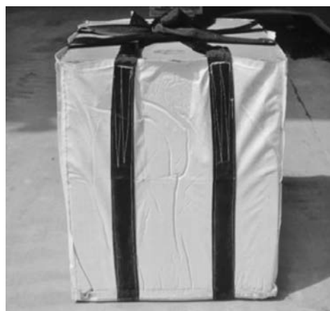
写真—4 亘理がれきを用いた本ブロック（B900 mm×W900 mm×H900 mm）
