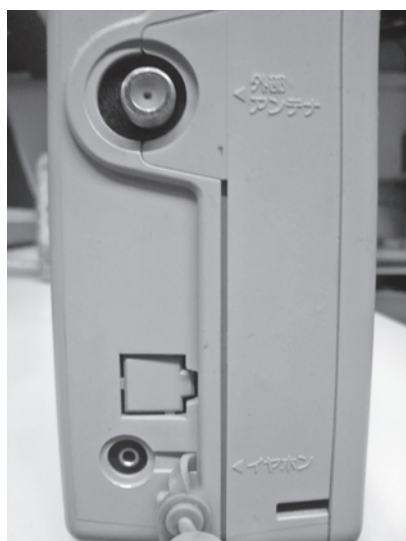
写真二 防災行政無線戸別受信機側面写真（音声出力端子）
