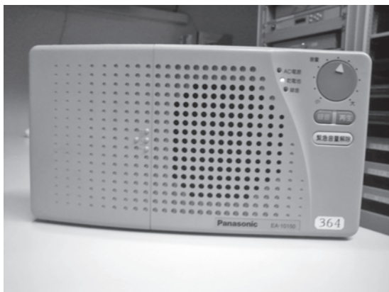
写真一 防災行政無線戸別受信機全体写真
