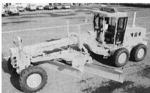
写真 4-104 作業幅員可変形ブレード（2 枚ブレード） 昭和 61 年
