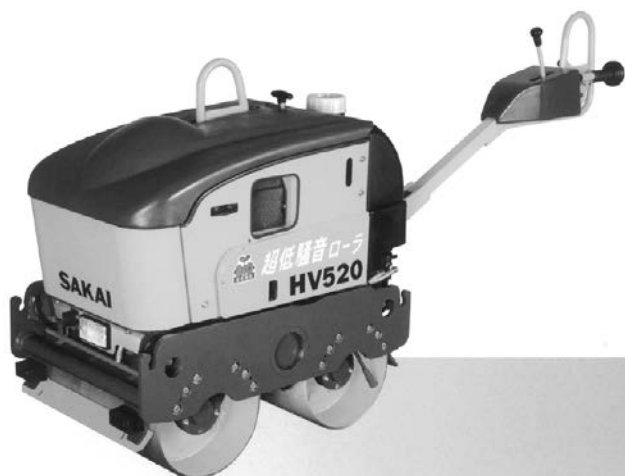
写真－3 酒井重工業 HV520 ハンドガイドローラ
