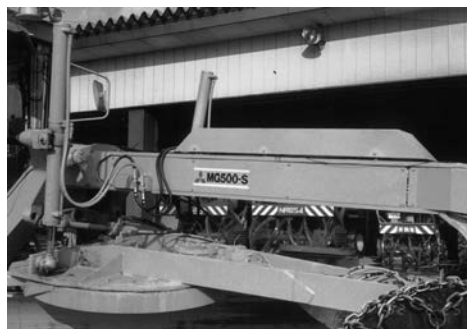
写真 4-112 ダイナミックダンパ 作業機式 平成 4 年
