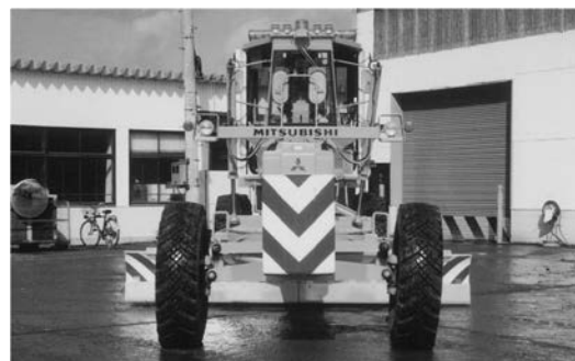
写真 4-105 作業幅員可変形ブレード（2 枚ブレード）による除雪作業
