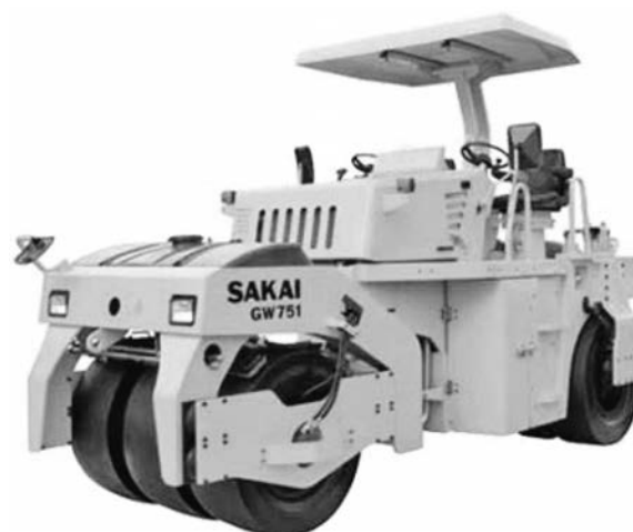
写真一 2 酒井重工業 GW751 振動タイヤローラ
