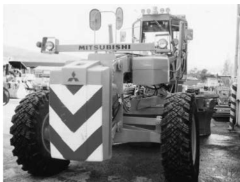
写真 4-108 MG500-S 溶液散布装置付 平成 4 年
