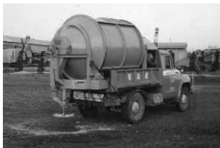
写真 6-5 ドラム式凍結防止剤散布装置 MS-R 型 範多機械(株) 昭和 41 ~ 44 年 旧建設省近畿地方建設局と共同開発
