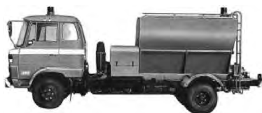
写真 6-8 スクリューコンベア式凍結防止剤散布車 MS-20FDT (M) 2m³ 範多機械(株) 昭和 49 ~ 50 年
