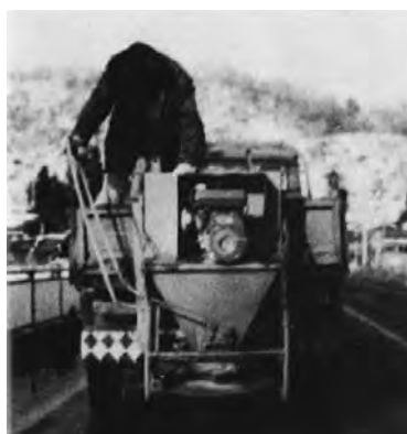
写真 6-3 簡易散布機(砂散布機) MS-G 範多機械(株) 昭和 40 年頃 4)
