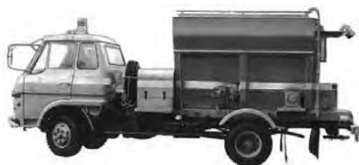
写真 6-9 ベルトコンベア式凍結防止剤散布車(専用車) MS-BDT (F) 範多機械(株)昭和 47 ~ 52 年
