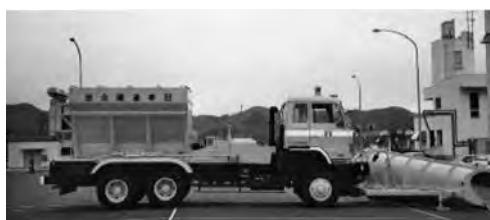
写真 6-12 ベルトコンベア式凍結防止剤散布車 MS-60BIT (F) 6 m 3 (除雪ブロー付) 範多機械(株) 旧日本道路公団 昭和 58 年
