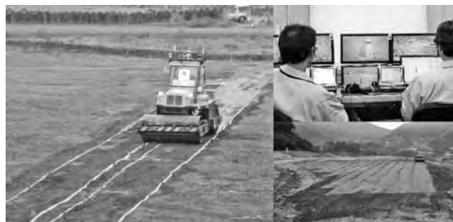
写真一3 自律転圧システムの検証状況
