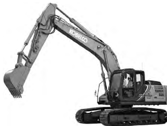
写真—3 コベルコ建機 SK200H-10 ハイブリッドショベル
