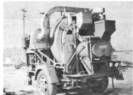
写真 3-22 MEMR-M52 型ポータブルアスファルトプラント 混合能力：4 t/h アスファルトタンク容量：800 L 原動機：水冷式 26PS 機関を装備
