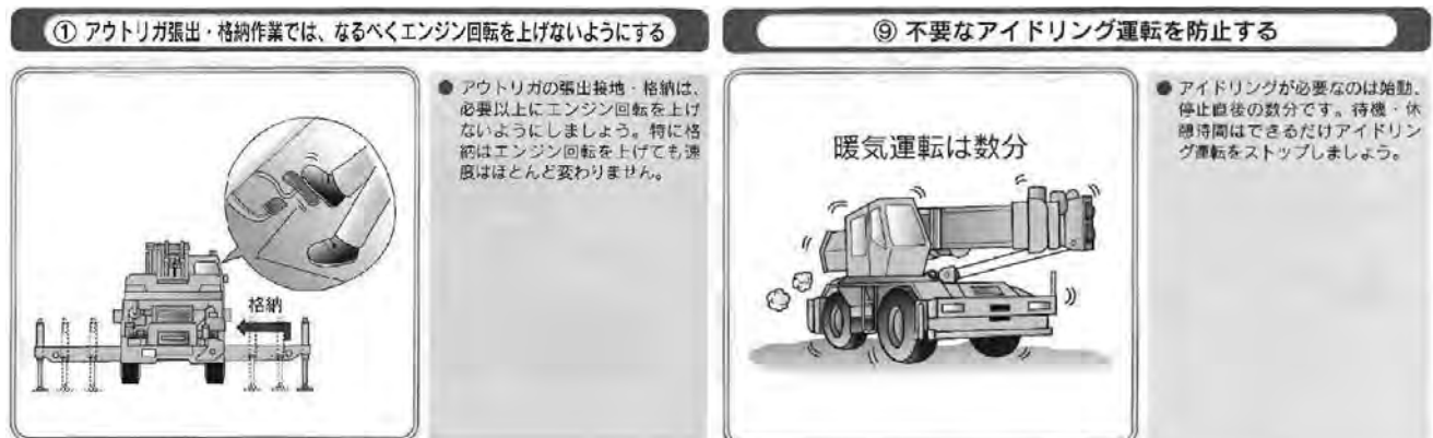
図－6 ホイールクレーンの省エネ運転事例
