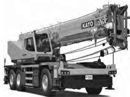
写真—6 加藤製作所 SL-500Rf PREMIUM ラフテレーンクレーン（伸縮ブーム形）
