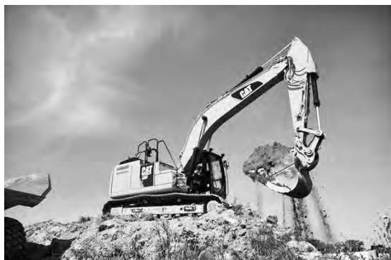
写真—5 キャタピラー・ジャパン Cat 326F L 油圧ショベル
