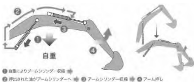
図一4 油圧回生回路
