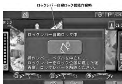
図—17 ロックレバー自動ロック機能作動時のモニタ表示
