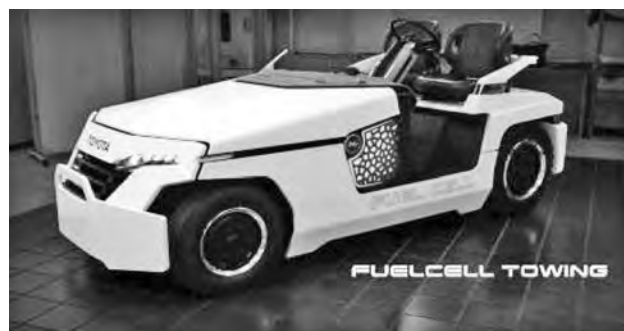
写真一四 FC トローイングトラクター（コンセプトモデル）
