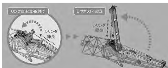
図—5 リヤボストの自力引き上げ
