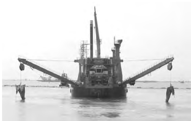
写真—3 アンカー打替状況
