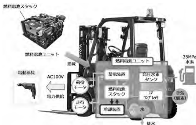
図—1 燃料電池システム概略図
