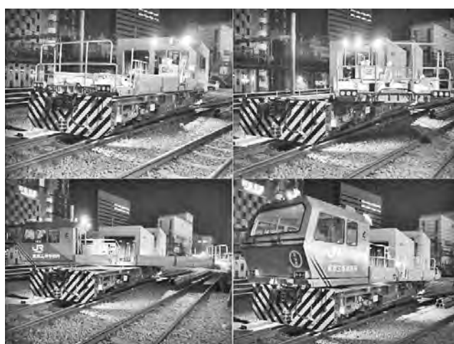
写真—11 KRC810N 方向転換ワゴン車
