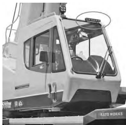
写真一七 ACS 外部表示灯
