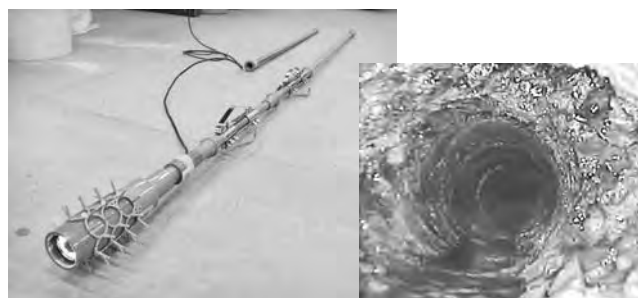
図—1 ボーリング孔内観察装置と観察画像
