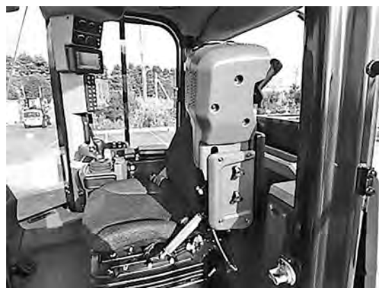
写真—5 跳ね上げ式レバーコンソール
