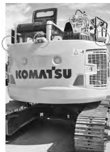
図—11 本システムカメラ設置状況
