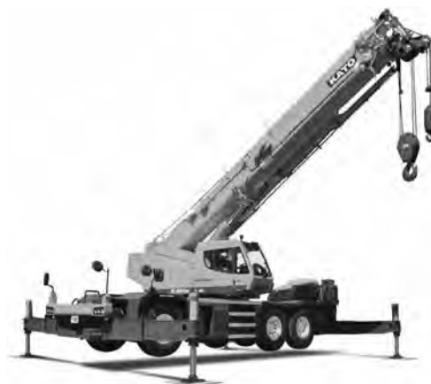
写真—7 加藤製作所 SL-500Rf PREMIUM ラフテレーンクレーン（伸縮ブーム形）
