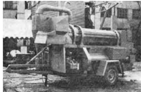
写真 3-21 パッチモビール 混合能力：5 t/h ドライヤ、ダストコレクタ、ミキサ、 ケトル（容量 950 L） アスファルトポンプ及び計量装置などを備えている
