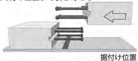
**鉛直に吊り降ろし、所定の位置に合わせる**
