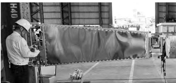
写真一3 動作実験(板金構造)
