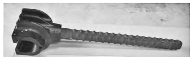
写真-7 改良後のコッター式継手
