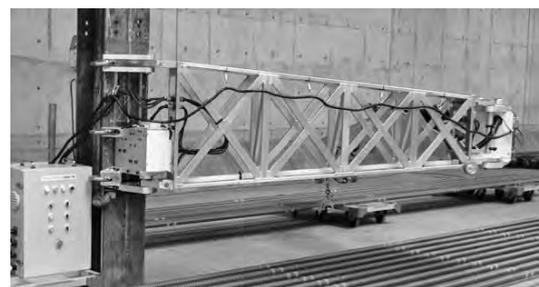
写真一4 変更後第一アーム構造写真
