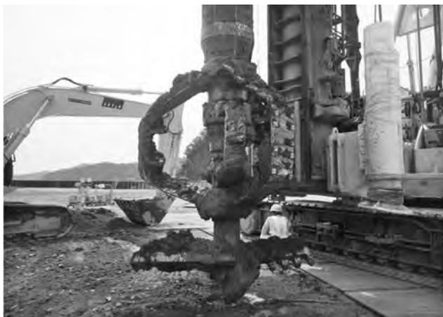
写真—5 エボコラム攪拌翼 (φ 2000 mm)
