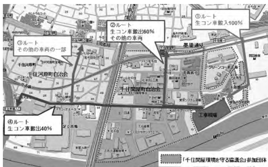
図—3 工事車両通行ルート図
