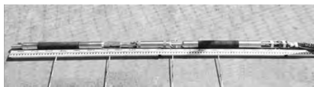
写真一 2 先端注入装置外観（実用機）
