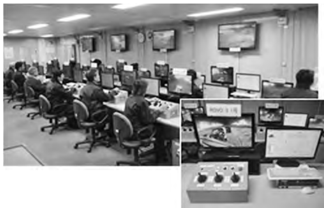
写真-4 遠隔操作状況（西側ケーソン）
