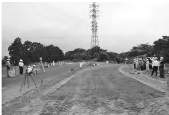
写真—4 TLS計測時（舗装面）
