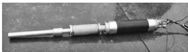
写真一 1 本工法先端注入装置外観（試作機）
