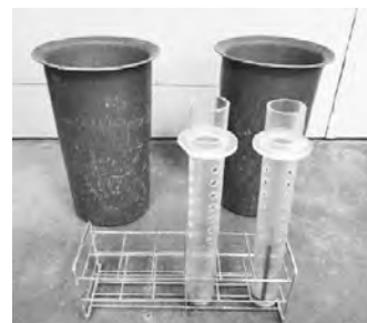
写真—2 円筒貫入試験器
