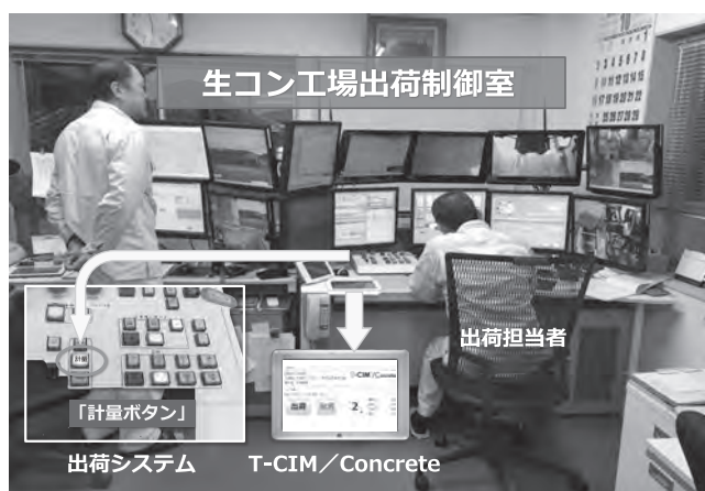
写真ー1 出荷担当者による運用状況 (出荷システムの計量と本システムの出荷)
