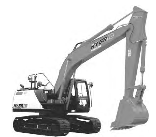
写真ー3 住友建機 SH200HB-7 ハイブリッド油圧ショベル
