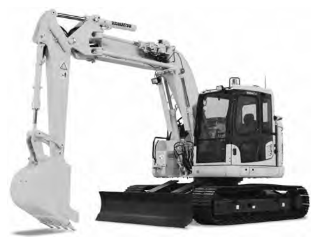
写真ー2 コマツ PC138UU-11 超小旋回型油圧ショベル (一部オプションが含まれる)
