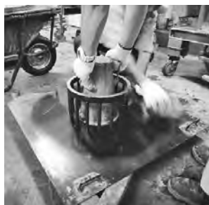
写真—1 J リング試験状況
