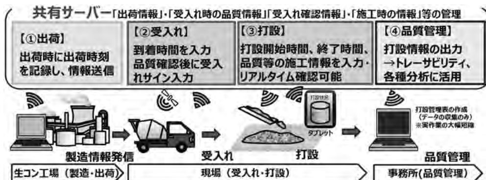
図-6 生コン工場からの製品情報電子化の運用イメージ
