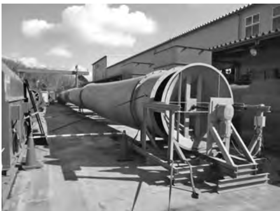
写真-14 3,000 m³/分（160 kW × 4 連）ファン性能試験
