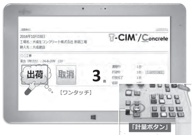
図一 10 生コン工場で運用する本システム画面（出荷システムの計量ボタンと本システムの出荷ボタン）
