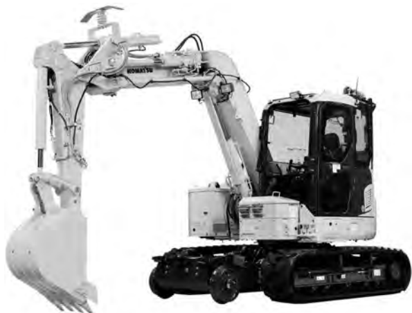
写真—1 コマツ PC78UUT-10 軌道陸上兼用油圧ショベル (一部オプションが含まれる)
