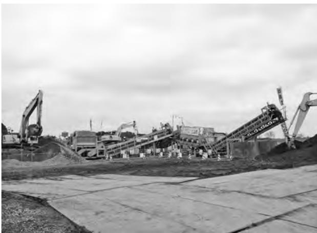
写真一五 万能土質改良機
