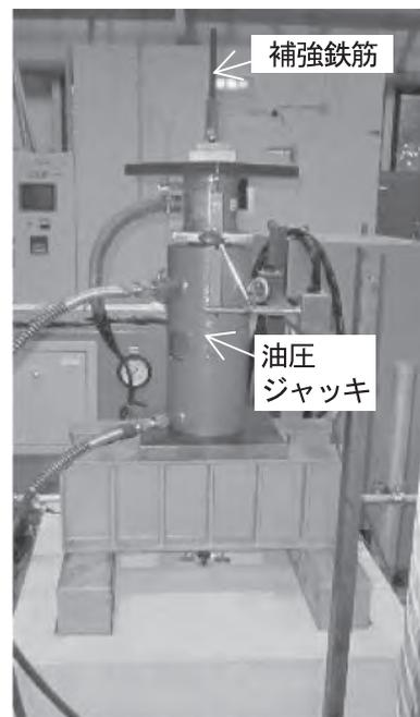
写真-1 引き抜き試験状況
