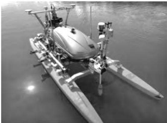
写真一 水中点検ロボット
