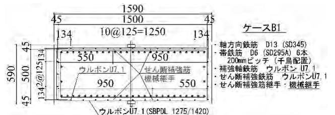
図一 4 補強配筋断面図 (ケース B1)
