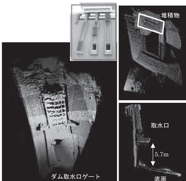
図-10 ROVによるダム取水口計測結果
