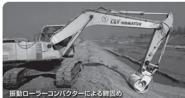
振動ローラーコンパクターによる締固め
