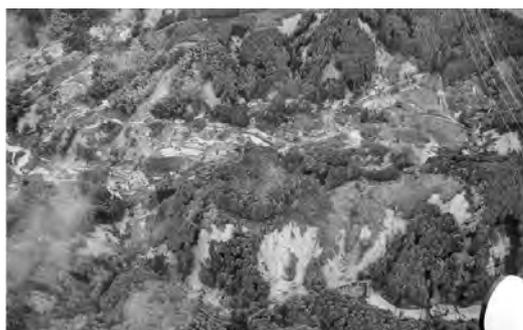
写真—1 同時多発的な斜面崩壊（北川）
