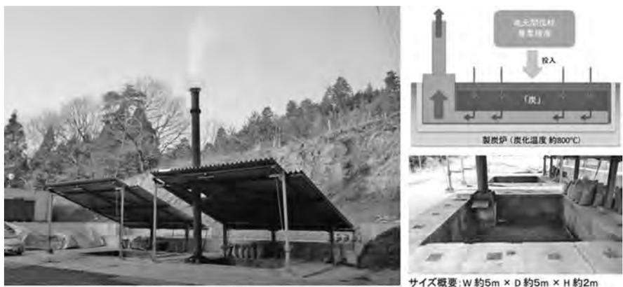
製炭炉 (高槻バイオマス粉炭研究所 高槻市)
