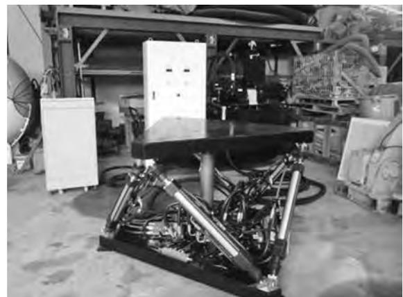
写真一 モーションベースプロトタイプ(左から制御装置、モーションベース、油圧ユニット)
