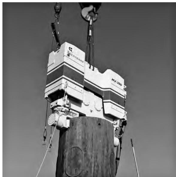
写真-4 調和工業 HV-300 バイブロハンマ (鋼管チャック)
