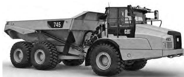
写真一 2 キャタピラージャパン Cat745 アーティキュレートダンプトラック
