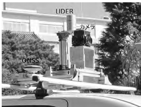
写真—3 自動運転車両のセンサー（LIDAR, GNSS, カメラ）
