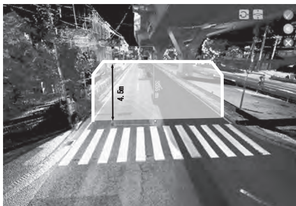
図一8 道路建築限界の確認
