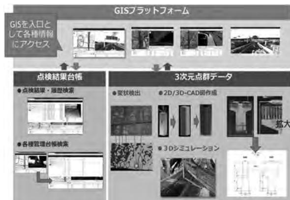
図-2 InfraDoctor システム概要図
