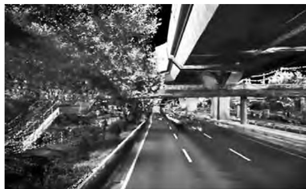
図-5 MMS で取得した点群データ
