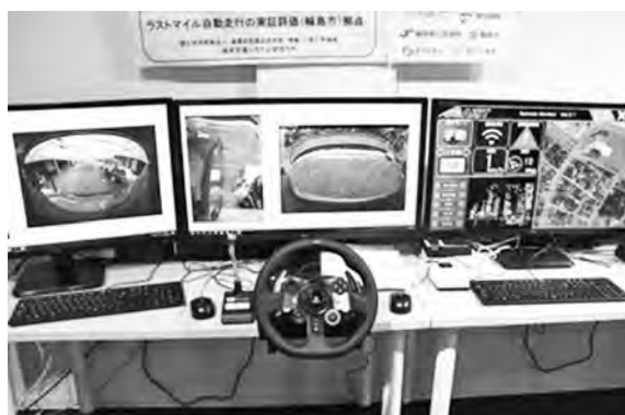
写真—3 遠隔監視・操作装置
