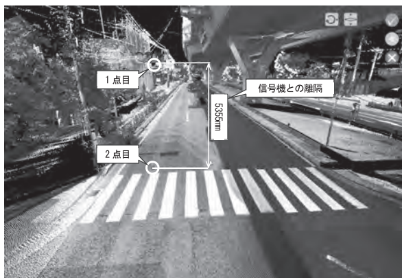
図一7 3D 寸法計測（高さ）
