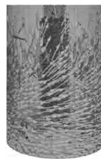
図-22 攪拌翼の回転速度が増大した場合の引抜孔下部における土粒子群の速度ベクトル (30 分後) (改良型エアリフト工法)
