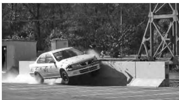
写真一 3 車両衝突試験状況 (試験条件 B)
