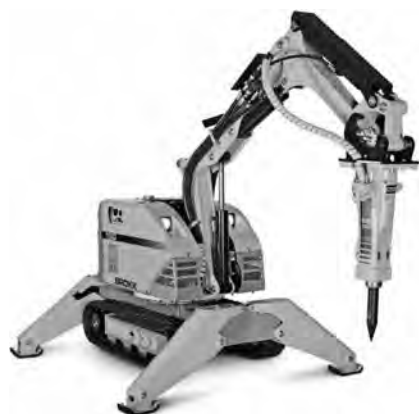
写真一 9 無人施工機械
