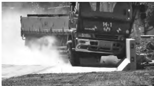
写真一 2 車両衝突試験状況 (試験条件 A)
