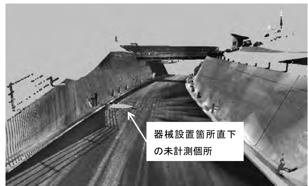
図-5 TLS で計測した点群データ
