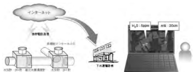
図—4 多機能型マンホールふたを使ったリアルタイム送信のイメージ
