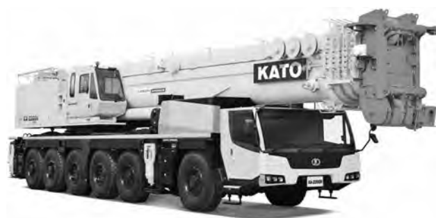
写真—4 加藤製作所 KA-2200R (構内走行姿勢) オールテレーンクレーン (伸縮ブーム形)
