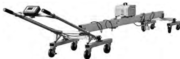
写真—7 東京計器 LP-3000 レーザ・プロファイラ
