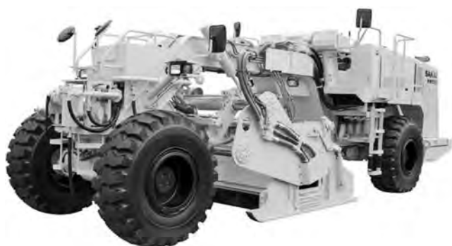
写真—1 スタビライザーの外観
