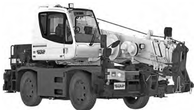
写真—3 タダノ GR-130NL/GR-130N ラフテレーンクレーン
