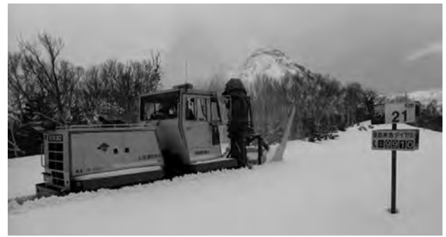
写真— 2 投雪中のロータリ除雪車
