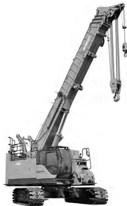
写真—5 コベルコ建機 TK550G テレスコピッククローラクレーン
