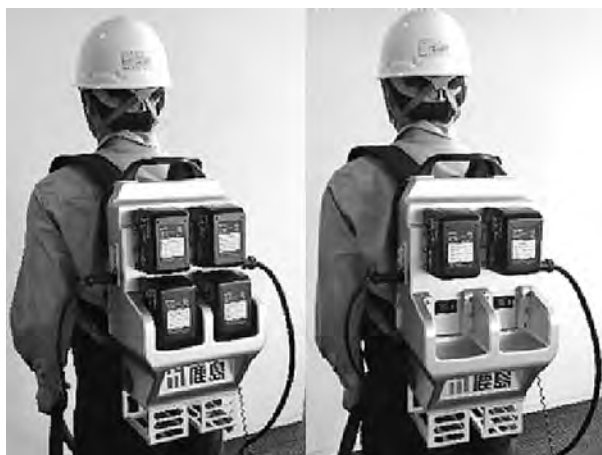
写真—5 改良機の外観(左:電池4個装備,右:電池2個装備)
