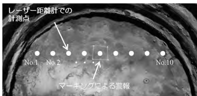
写真-3 マーキングによる不安定部の明示 3)
