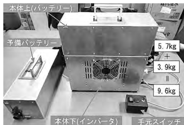
写真—3 本開発機の外観
