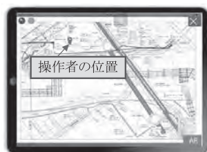
写真—4 タブレット端末の画面 （図面表示）
