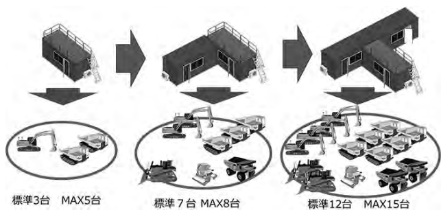
図一3 拡張型高機能遠隔操作室の拡張性
