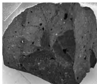
図—5 波長 580 nm での反射強度イメージ (玄武岩)
