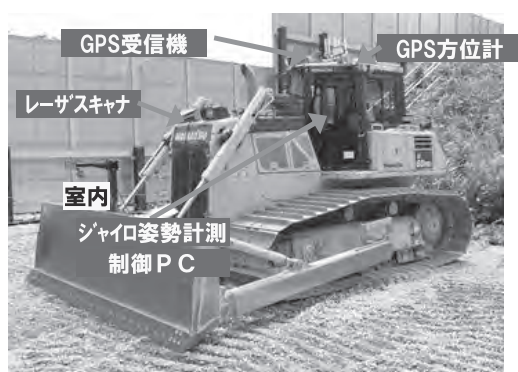
図一 ブルドーザの自動化システム
