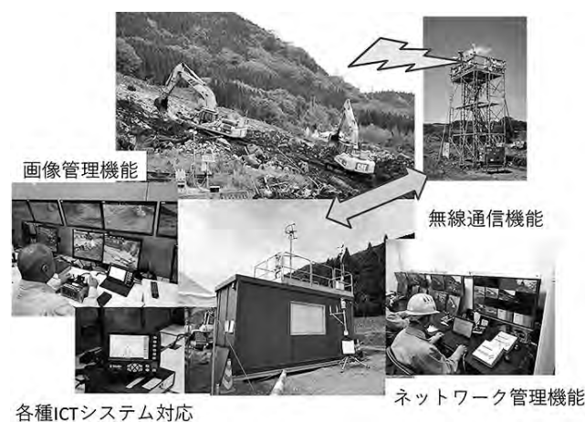
図一 2 高機能遠隔操作室の機能
